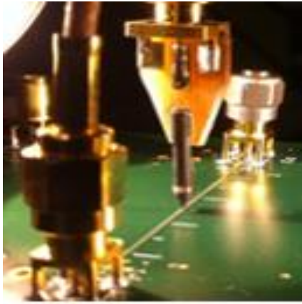
Fig. 3.3: Injection en champ proche sur ligne micro-ruban
