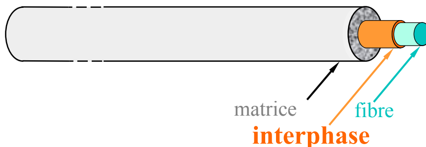
Figure II.11 : Schéma d'un microcomposite.
