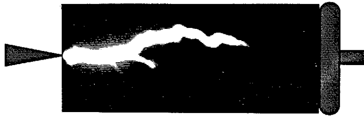
Figure II.8: Intégration de la lumière émise par un streamer au cours de sa propagation.
