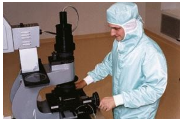
Figure 31: Photo-répéteur David Mann du département optique
