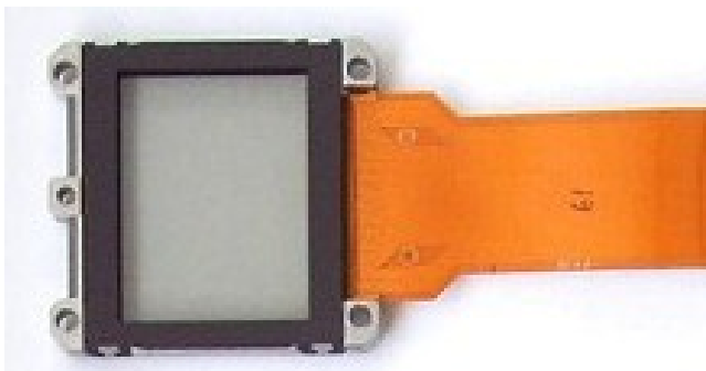
Figure 9: Exemple de MSL en transmission à CL nématique (Epson)
