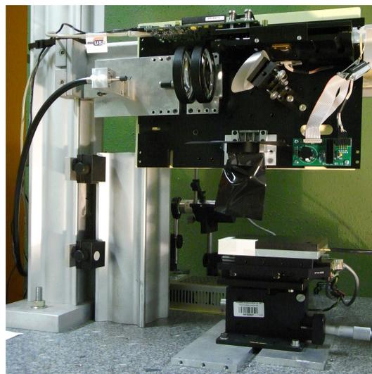
Figure 37: Photographie du phototraceur à DMD "PRINT"
