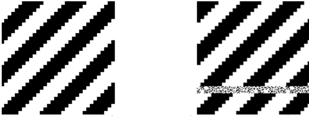
Figure 17: Illustration du schéma d'adressage "fenêtre glissante". A gauche réseau initial, à droite le réseau en cours de modification avec en haut le nouveau réseau décalé, en bas le réseau initial et entre les deux la zone de transition.
