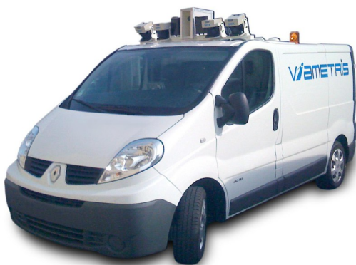
Figure 6: Véhicule Viamétris équipé pour le relevé et géolocalisation de la signalisation routière.
