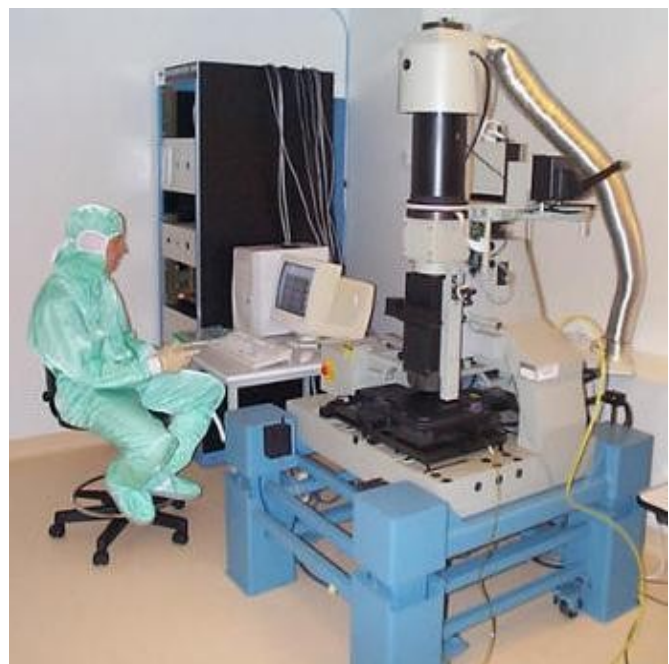
Figure 33: Phototraceur "DRAWMAP" basé sur un MSL à CL
