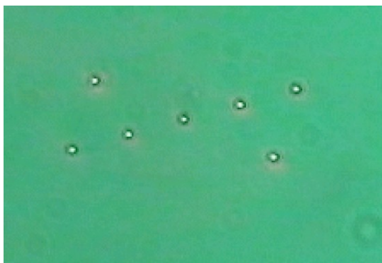
Figure 16: Microsphères de polystyrène prises dans des pièges optiques, générés par MSL et multiplexés temporellement. Les 5 pièges alignés sont fixes, les deux autres sont mobiles.
