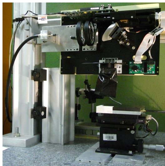
Figure 37: Photographie du phototraceur à DMD "PRINT"
