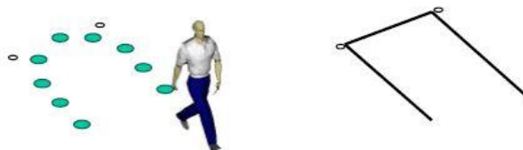
Figure 39: Détection de POIs par analyse de la trajectoire PDR [70]
