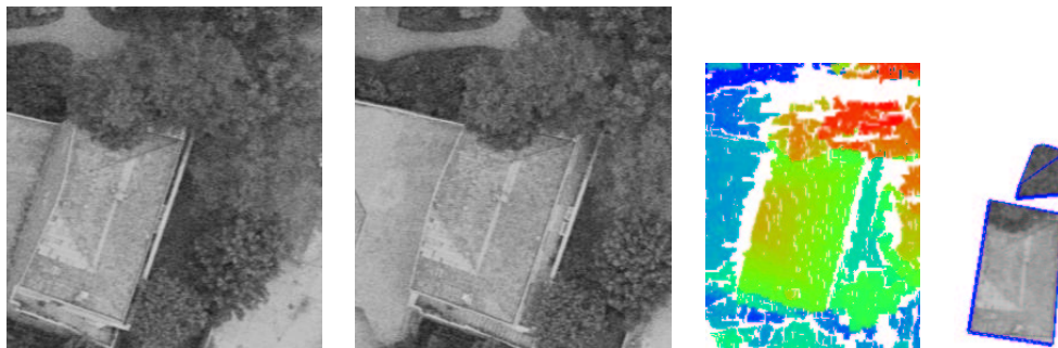
FIG. H.69 – Couple stéréoscopique, MNE, et reconstruction finale pour la zone 51
