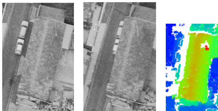
FIG. H.63 – Couple stéréoscopique, MNE, et reconstruction finale pour la zone 59
