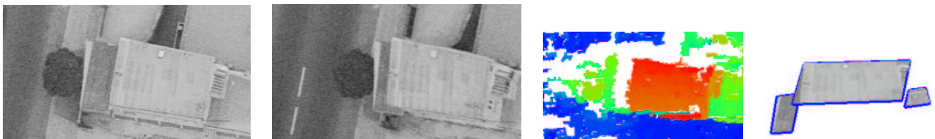
FIG. H.47 – Couple stéréoscopique, MNE, et reconstruction finale pour la zone 82
