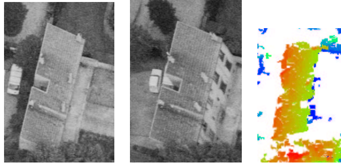
FIG. H.42 – Couple stéréoscopique, MNE, pour la zone 93. Pas de reconstruction pour cette zone.
