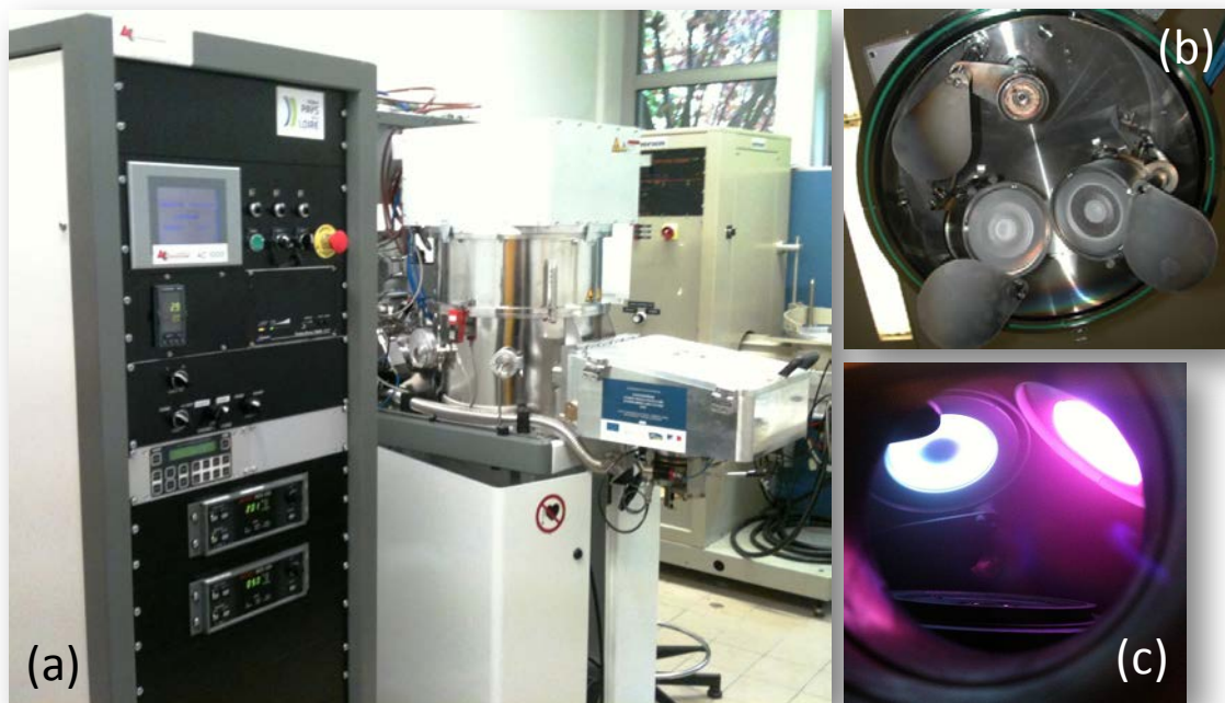
figure A.9 Photographies du réacteur de pulvérisation cathodique magnétron AC-450 de Alliance Concept. (a) Vue d'ensemble avec à gauche la console de contrôle des différents paramètres de dépôt ; (b) Vue du dessous de l'intérieur de l'enceinte où l'on distingue les 3 cibles, caches ouverts, la petite de 1 pouce en haut et les 2 grandes de 2 pouces en bas en position confocale ; (c) Vue de côté des 2 cibles en confocale pendant un dépôt par co-pulvérisation magnétron (on aperçoit en bas le porte échantillon).
