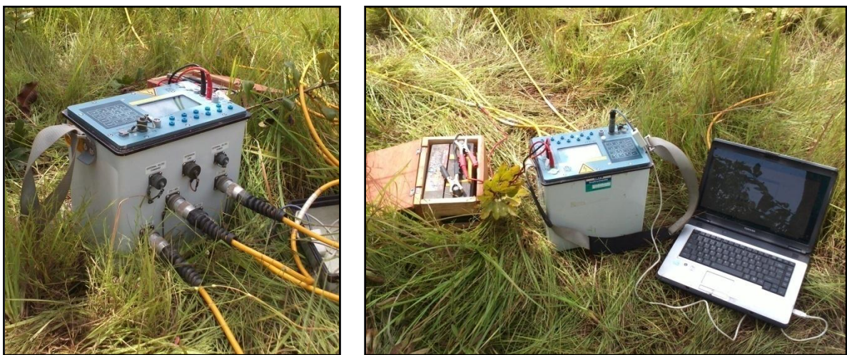
Figure 21: Vues du Syscal Pro. A gauche, l'arrière de l'appareil avec les connexions directes sur les switches internes ; A droite, le Syscal Pro avec la batterie externe pour l'injection de courant et l'ordinateur de terrain pour le transfert des protocoles et des données.
