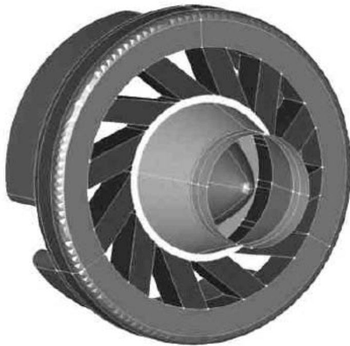
FIG. 3.9 – Vue avant du swirler (CAO) et détail sur les douze fentes ainsi que sur le nez
