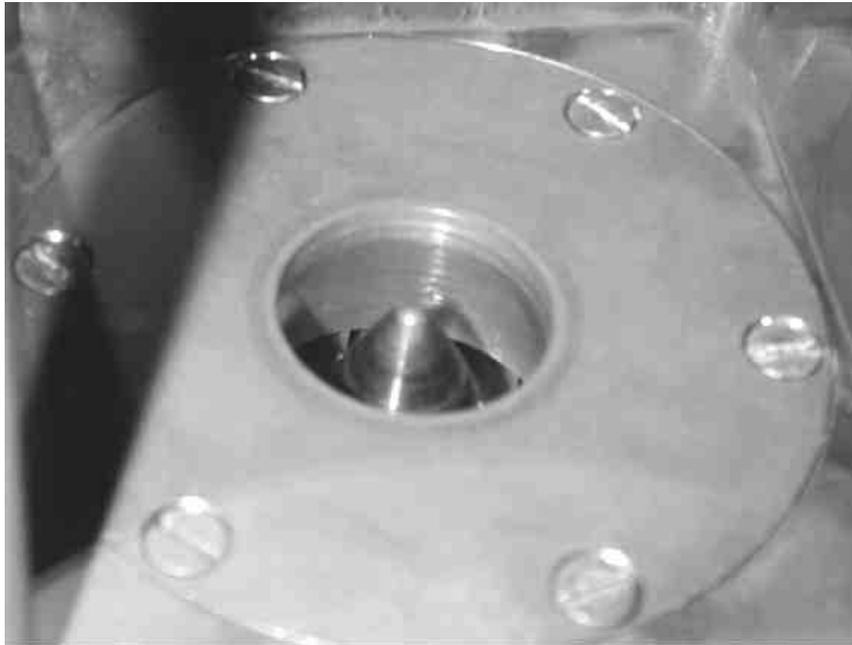
FIG. 3.5 – Cône central du swirler (en place, vu de la chambre)
