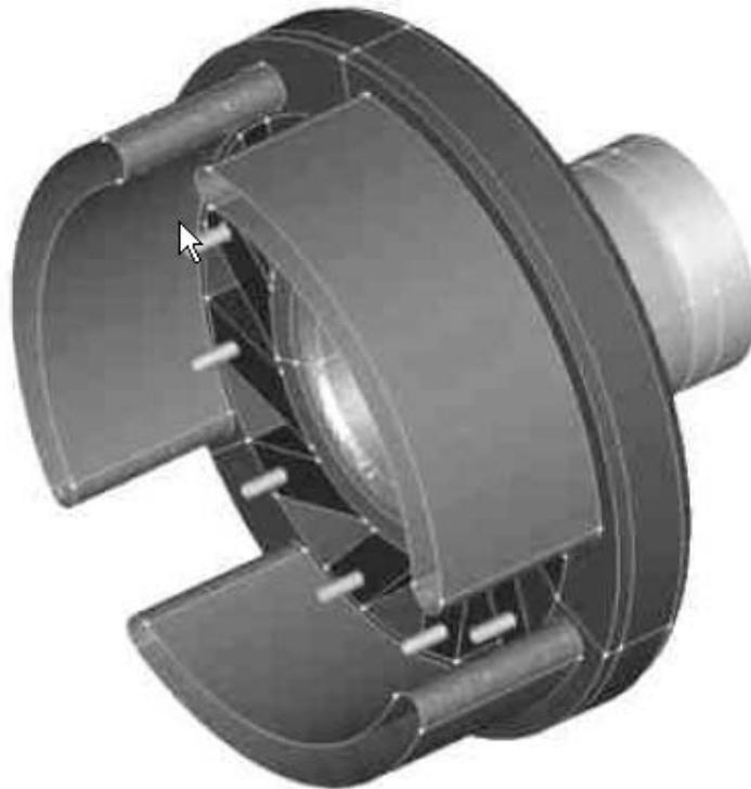
FIG. 3.8 – *Vue arrière du swirler (CAO) avec les douze trous d'injection de méthane et les trois fentes d'alimentations en air*
