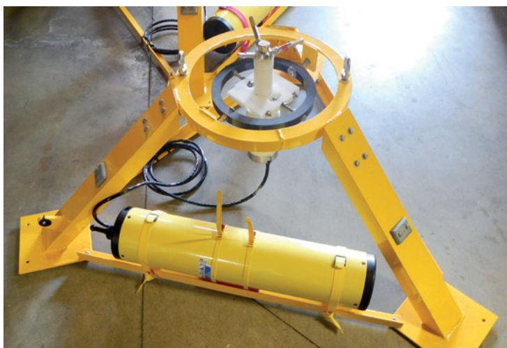
Figure 64 : L'ADV de l'IGARUN utilisé pour la campagne de mesures
