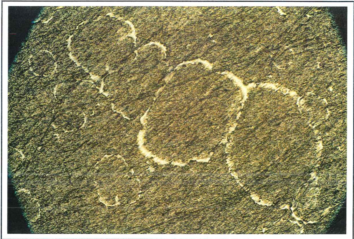
Figure 63a Observation des "ronds" à la surface des éprouvettes vieilles (2 mois sous UV, avec alternance de phases à 20%HR et à 100%HR)
