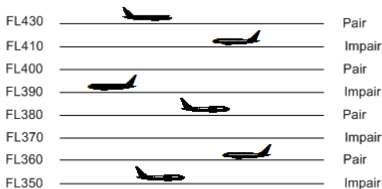
FIGURE 3: NIVEAU DE SÉPARATION SUR LE PLAN VERTICAL
