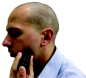
Figure 2.52: Exemple de mesure in vivo par un cutomètre (1)
