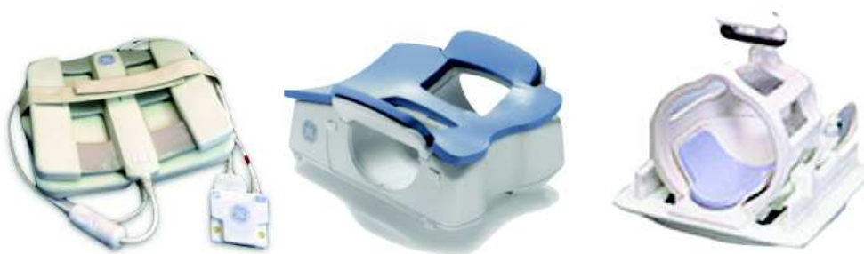
Figure 3.1: Différentes types d'antennes radiofréquence utilisées au cours de nos acquisitions (thorax, sein, et crâne)
