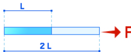
Figure 2.37: Schématisation de la signification de E pour une poutre déformable.
