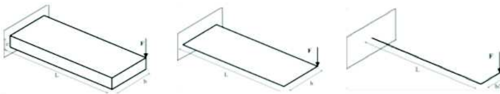
Figure 3.27 : Différents types de modèles utilisés : volumique (figure de gauche), membranaire (au milieu) et linéique (à droite)
