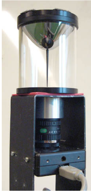
FIGURE 2.12 – Système catadioptrique composé d’une caméra et d’un miroir hyperbolique.
