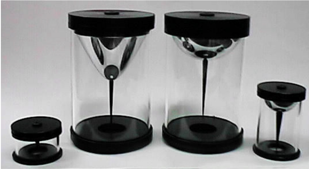
FIGURE 2.5 – Différents types de miroirs composant un capteur catadioptrique
