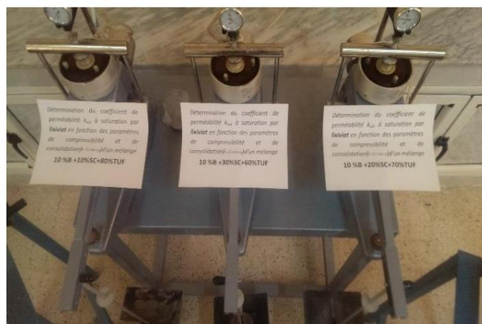
Figure 3:27 Trois cellules œdométriques.
