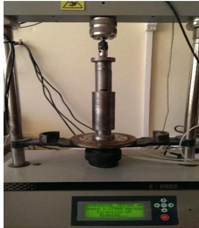
Figure 4:5 Compactage statique des éprouvettes.
