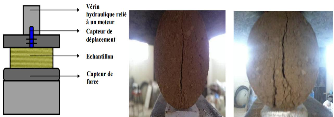
Figure 3:35 Schéma de principe d'écrasement par fendage.
