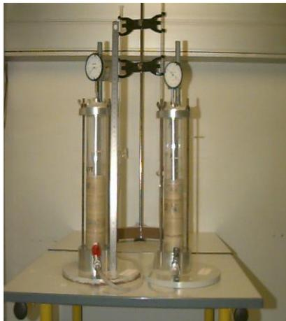
Figure 2:17 Vue d'ensemble du dispositif expérimental (Sayad-Gaidi, 2003).
