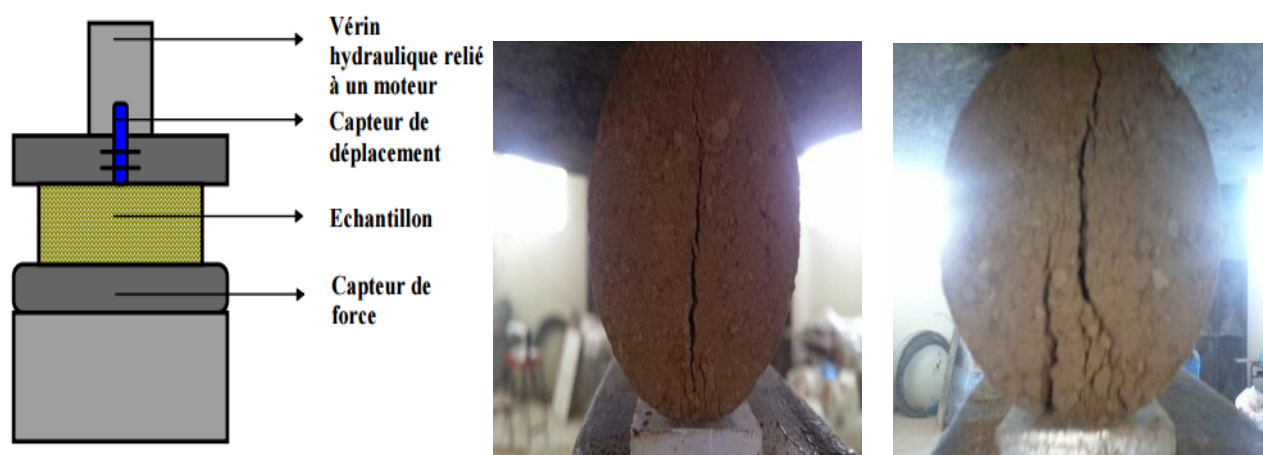
Figure 3:35 Schéma de principe d'écrasement par fendage.
