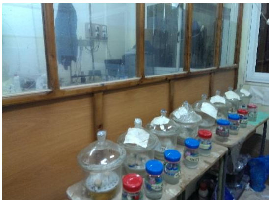
Figure 4:19 Mise en place du dispositif expérimental (méthode des dessiccateurs) (Laboratoire de Recherche de Génie Civil (LRGC), université de Laghouat).
