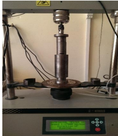
Figure 4:5 Compactage statique des éprouvettes.
