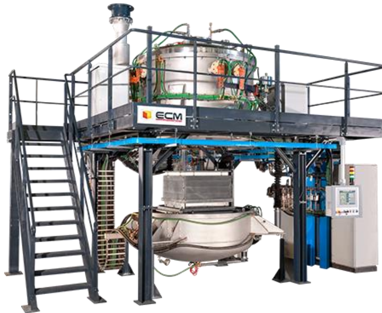
Figure I-1 : Four ECM PV600 utilisé pour la cristallisation de lingots de silicium de grandes dimensions (Source ECM-Greentech). Le creuset de taille G6 (environ 1\text{ m} \times 1\text{ m} \times 34\text{ cm} pour un lingot de 800kg) permet de solidifier le lingot en un cycle de l'ordre de 70 à 80 heures.
