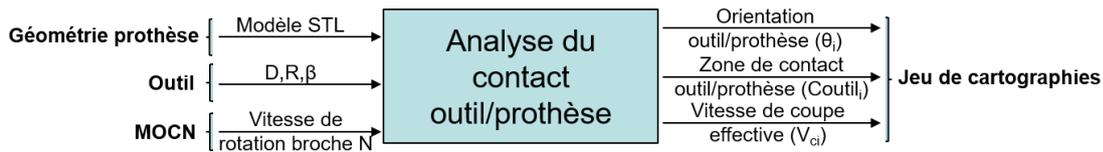
FIGURE 6.2.13 – Module d'analyse du contact outil-prothèse
