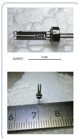
Figure 6.3. Diapason à quartz (QTF = quartz tuning fork) utilisé.
