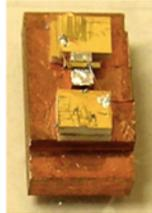
**Figure 5.14. Embase spécifique pour le montage des diodes lasers CRISPI : deux céramiques sont nécessaires pour les deux reports de contacts des 2 cavités. L'émission peut être mesurée par les deux facettes émettrices.**
