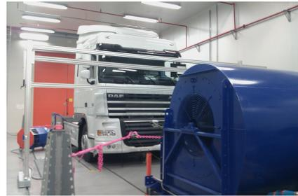
**Figure 6.11. VELA (Vehicule Emission Laboratory) 7, enceinte de mesure dédiée aux poids lourds, JRC, Ispra.**
