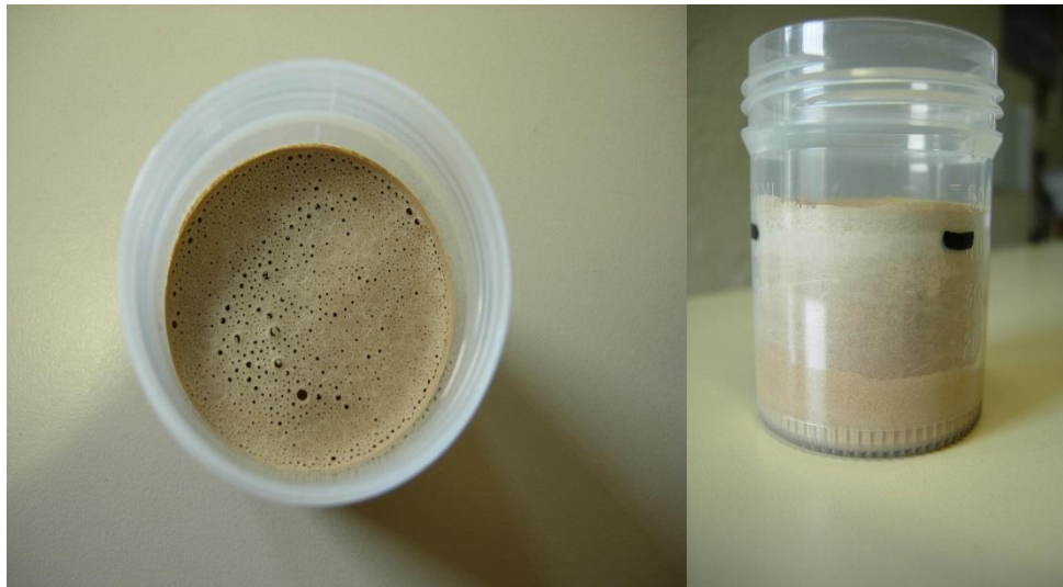
Figure 3.1 : L'échantillon de l'essai du suivi de la perte de masse sur une pâte pure ettringitique
