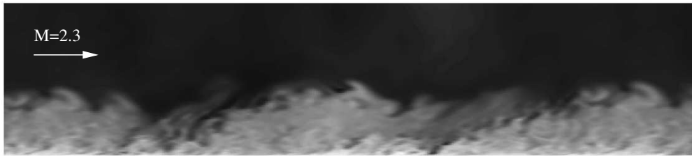
FIG. 3.1 – Simulation LES d'une couche limite turbulente supersonique. Champ instantané de masse volumique.
