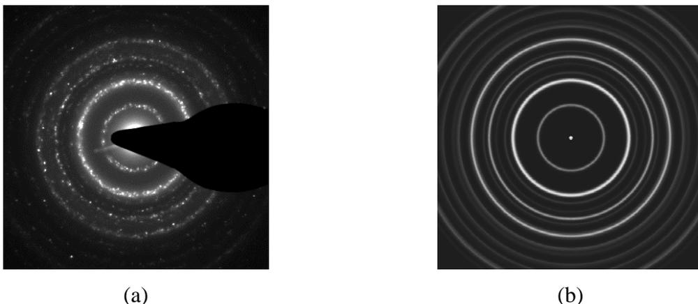
Figure 4-2 : diffraction électronique du composé  $\text{La}(\text{OH})_3$  (a) expérimentale et (b) simulée (chapitre 3, III-A-1).
