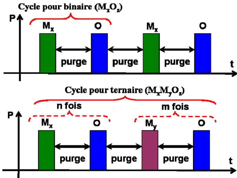
Figure 2-14 : cycles réalisés en ALD pour le dépôt d'oxydes binaire et ternaire.
