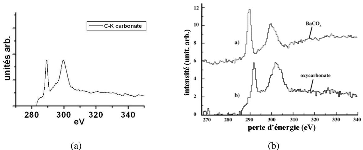
Figure 4-3 : distribution caractéristique du seuil K du carbone obtenue (a) dans notre expérience et (b) à partir du carbonate de baryum et de l'oxycarbonate de baryum et titane [Gablenz2000].
