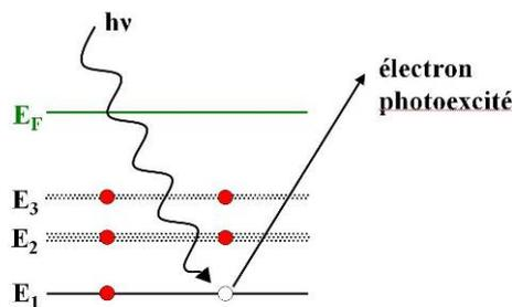
Figure 3-4 : schéma de principe de l'XPS.
