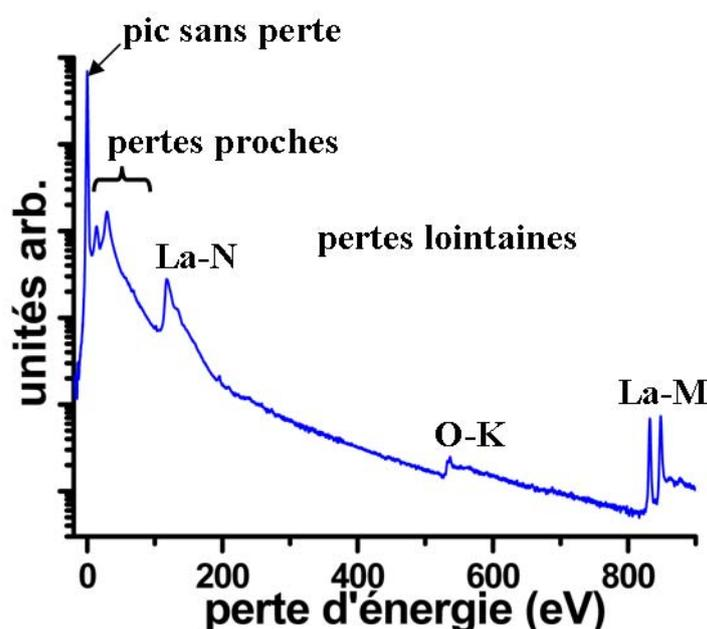
Figure 3-18 : spectre EELS de  $\text{La}_2\text{O}_3$  dans la fenêtre d'énergie [0-900] eV. L'échelle d'intensité est logarithmique pour permettre la vision globale du spectre dont la dynamique est très importante.
