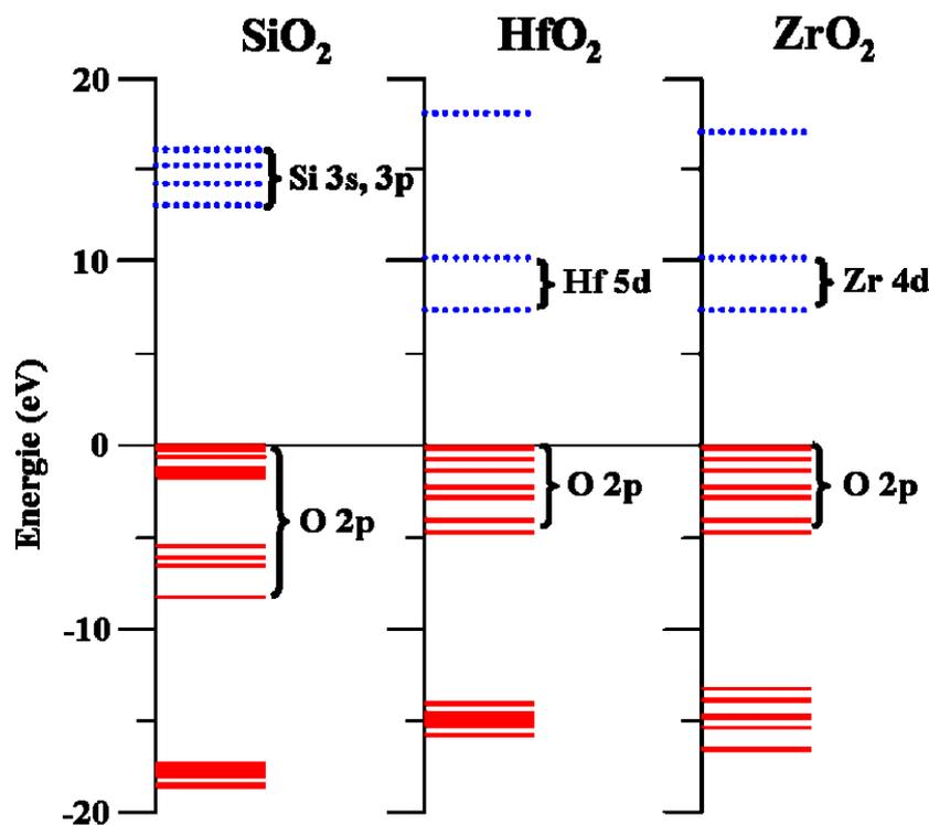
Figure 2-8 : diagramme des niveaux d'énergie de  $ZrO_2$  et d' $HfO_2$  comparés à celui de  $SiO_2$  [d'après Ikarashi2003].
