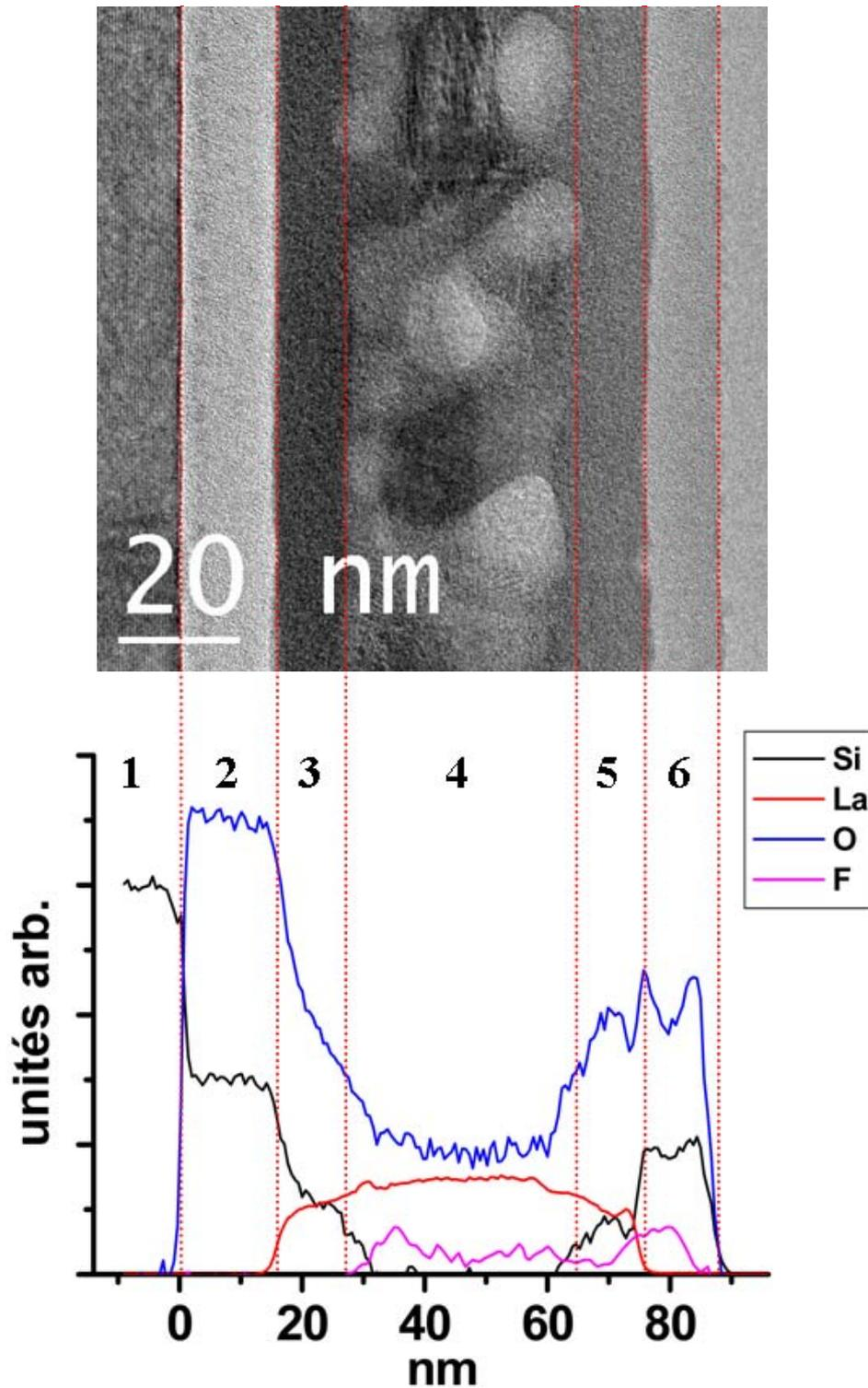
Figure 4-12 : système permettant de conserver la phase hexagonale de  $\text{La}_2\text{O}_3$  à l'abri de l'humidité de l'air et du carbone et profils chimiques correspondants.
