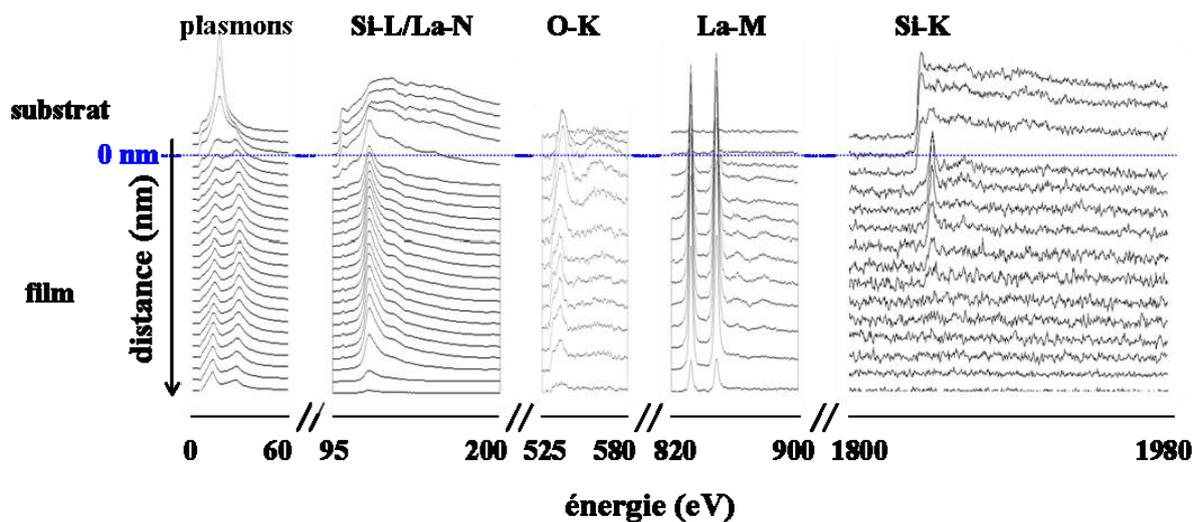
Figure 3-20 : ensemble des spectres-lignes acquis le long d'une trajectoire allant d'un substrat de Si vers un film La<sub>2</sub>O<sub>3</sub>. Les distributions caractéristiques enregistrées sont identifiées sur la figure. "0 nm" indique la position de l'interface Si/film.
