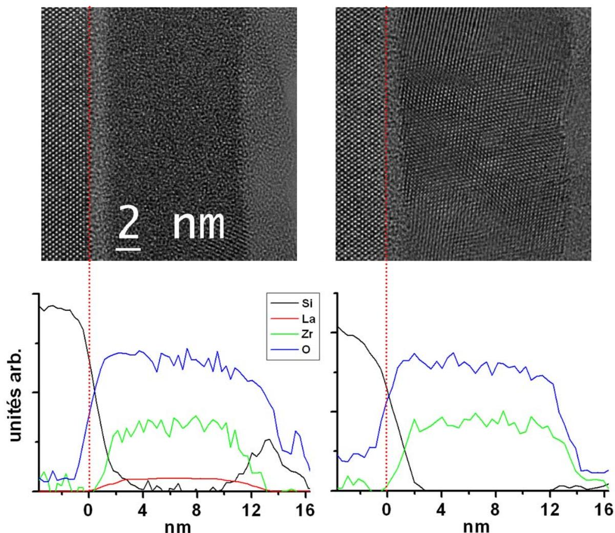
Figure 5-5 : état de cristallisation et profils chimiques de films ZrO<sub>2</sub> bruts d'élaboration déposés sur silicium avec (a) du lanthane et (b) sans lanthane.
