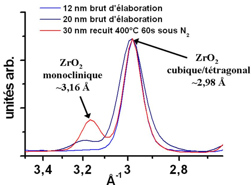
Figure 6-5 : diffraction électronique et profils correspondants rendant compte de l'apparition de la phase monoclinique de ZrO<sub>2</sub> dans les films épais et/ou recuits.
