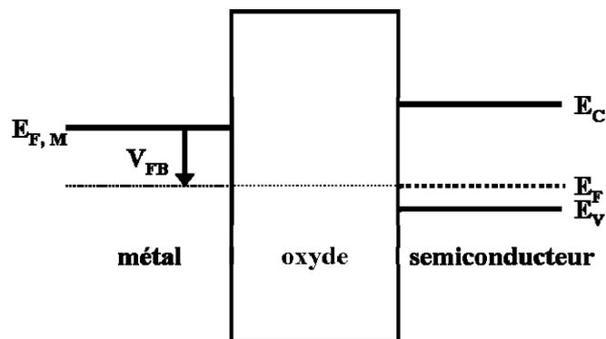
Figure 3-5 : mise en évidence de la tension de bande plate  $V_{FB}$  à appliquer au dispositif pour mettre au même niveau les énergies de Fermi du métal (grille) et du semiconducteur (substrat).
