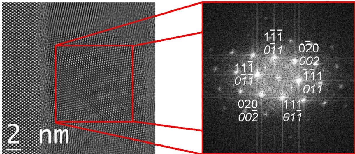
Figure 3-16 : FFT d'une projection cristallographique. Dans ce cas de figure précis, l'indexation peut se faire avec  $c\text{-ZrO}_2 [101]$  (normal) et  $te\text{-ZrO}_2 [100]$  (italique).
