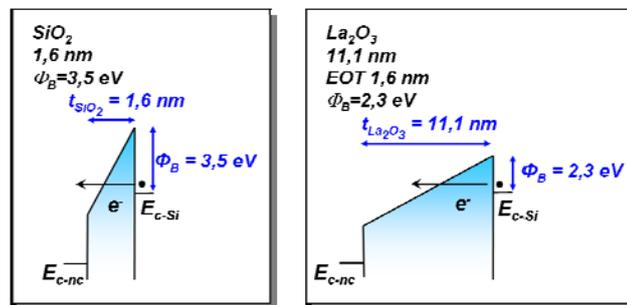
Figure 1-10 : comparaison des structures de bandes de la silice ( $\kappa = 3,9$ ) et de  $La_2O_3$  ( $\kappa = 27$ ) [Scarel2007].
