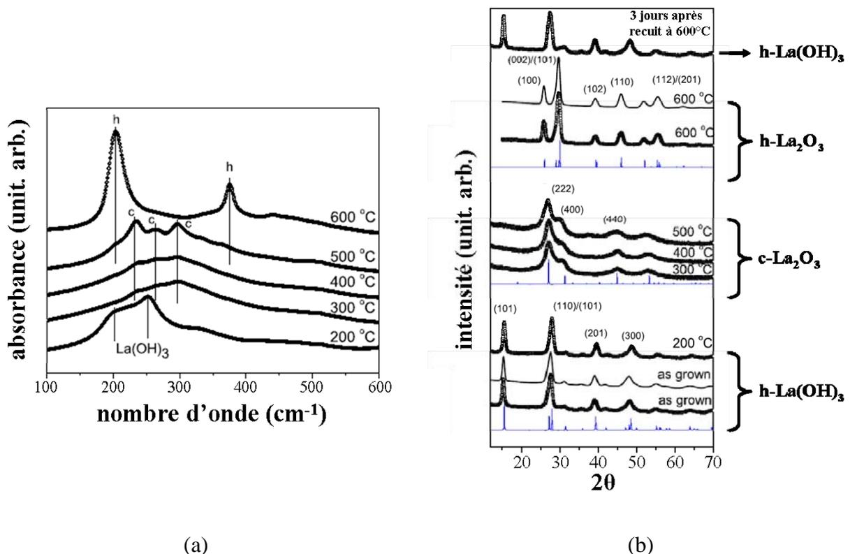
Figure 4-11 : évolution chimique des composés à base de lanthane en fonction de la température de recuit analysée par (a) FTIR et (b) GIXRD [Tsoutsou2008].
