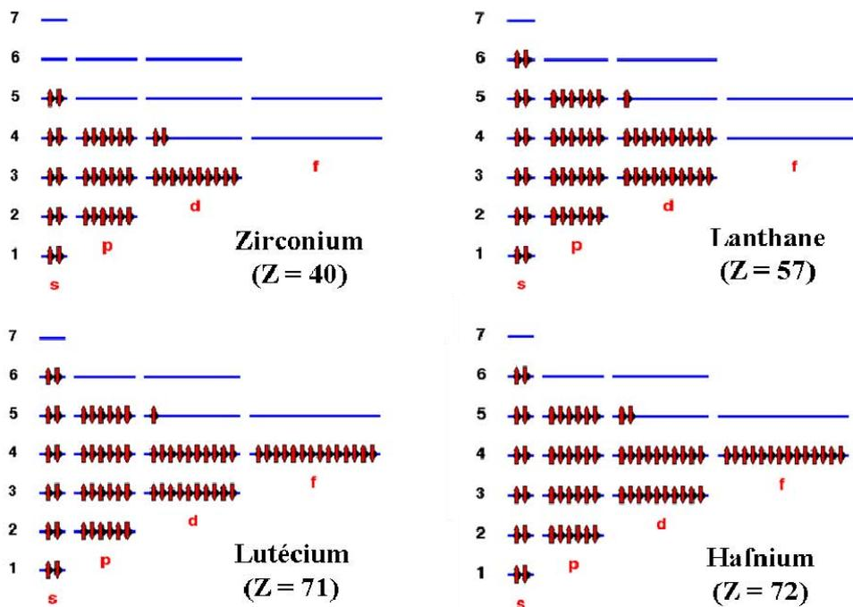
Figure 2-1 : remplissage des niveaux électroniques du zirconium, du lanthane, du lutécium et de l'hafnium.
