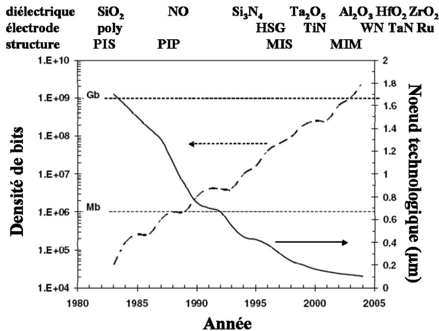
Figure 1-11 : Evolution de la production des mémoires volatiles DRAM (noeud technologique) et de leur capacité mémoire (densité de bits) en fonction du temps. Les modifications de matériau diélectrique et d'électrode ainsi que la structure de l'empilement sont précisées (PIS : polysilicium/isolant/silicium, PIP : polysilicium/isolant/polysilicium, MIS : métal/isolant/silicium, MIM : métal/isolant/métal) [Gerritsen2005].
