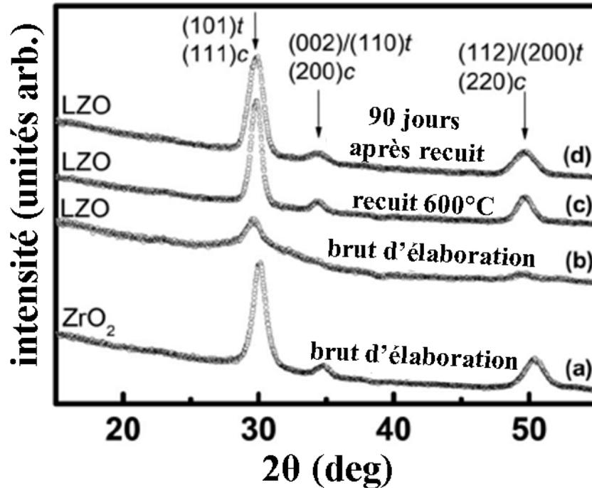
Figure 5-1 : GIXRD de films de 24 nm d'épaisseur de (a)  $ZrO_2$  et (b), (c) et (d)  $LaZrO$  respectivement brut d'élaboration, recuit  $600^\circ C$  sous vide pendant 60s et relaxé 90 jours après recuit [Tsoutsou2009].
