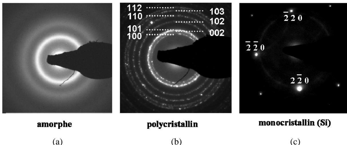
Figure 3-11 : clichés de diffraction électronique d'un film (a) amorphe, (b) polycristallin (cas de la structure hexagonale de  $\text{La}_2\text{O}_3$  (fiche ICSD 28555)) indexé et (c) d'un substrat de Si monocristallin en axe de zone [100].
