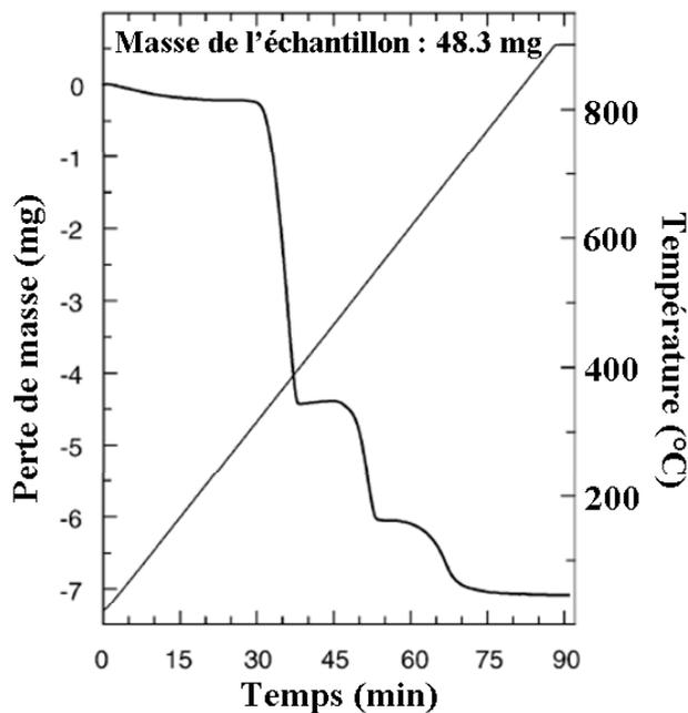
Figure 2-11 : Diagramme d'analyse thermogravimétrique pour  $\text{La}_2\text{O}_3$ .
