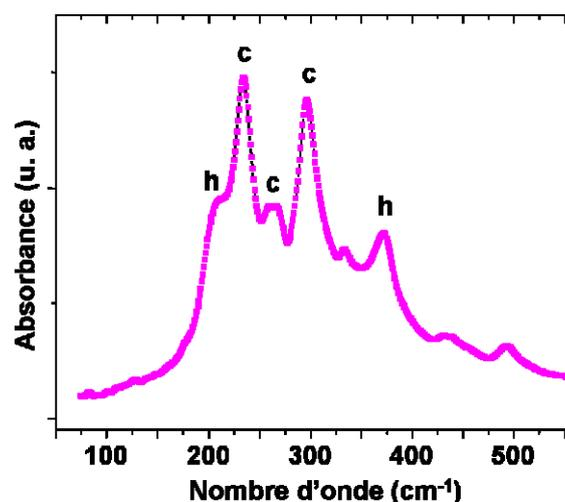
Figure 3-3 : profil de l'absorbance en fonction du nombre d'onde obtenu par FTIR. Dans ce cas de figure,  $\text{La}_2\text{O}_3$  cubique (c) et hexagonal (h) sont présents dans le même film (données MDM).
