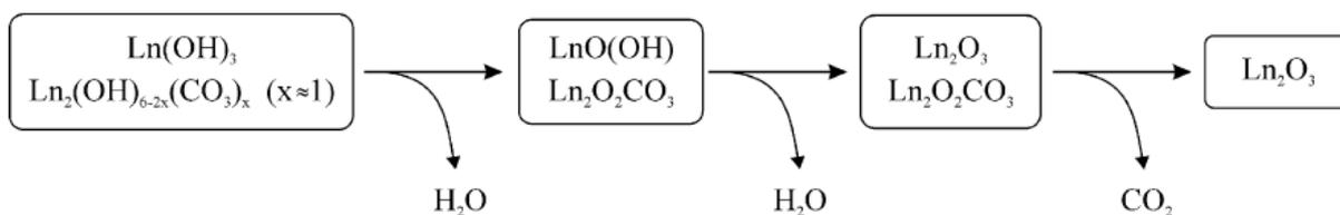
Figure 2-12 : schéma réactionnel aboutissant au sesquioxyde  $\text{Ln}_2\text{O}_3$ .
