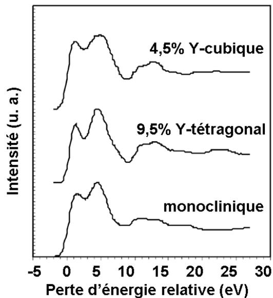
Figure 3-30 : ELNES des phases cubique, tétragonale et monoclinique de Y-ZrO<sub>2</sub> [McComb1996].
