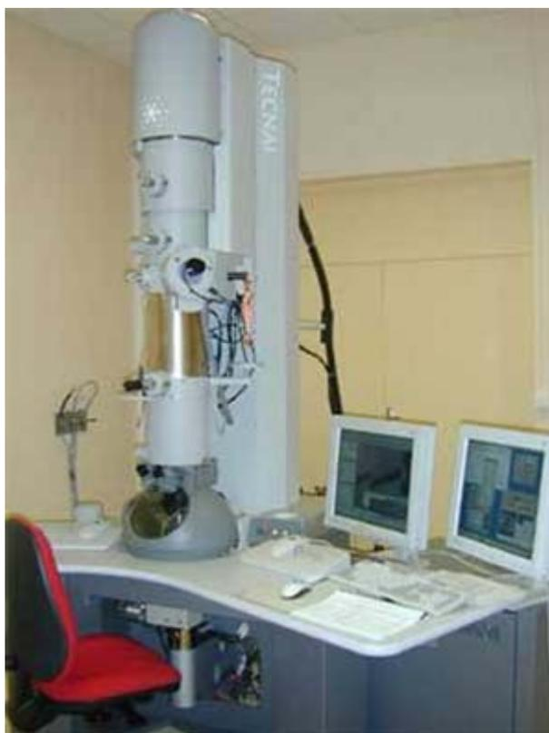
Figure A3-1 : SACTEM FEI Tecnai™ F20. Le correcteur d'aberration sphérique est situé sous la lentille objectif (partie brillante au niveau de la colonne).
