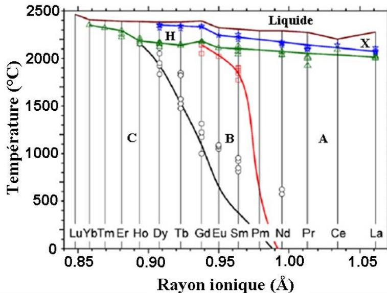
Figure 2-4 : diagramme de phase expérimental (Analyse Thermique Différentielle) des sesquioxydes de terres rares [Zinkevich2007].
