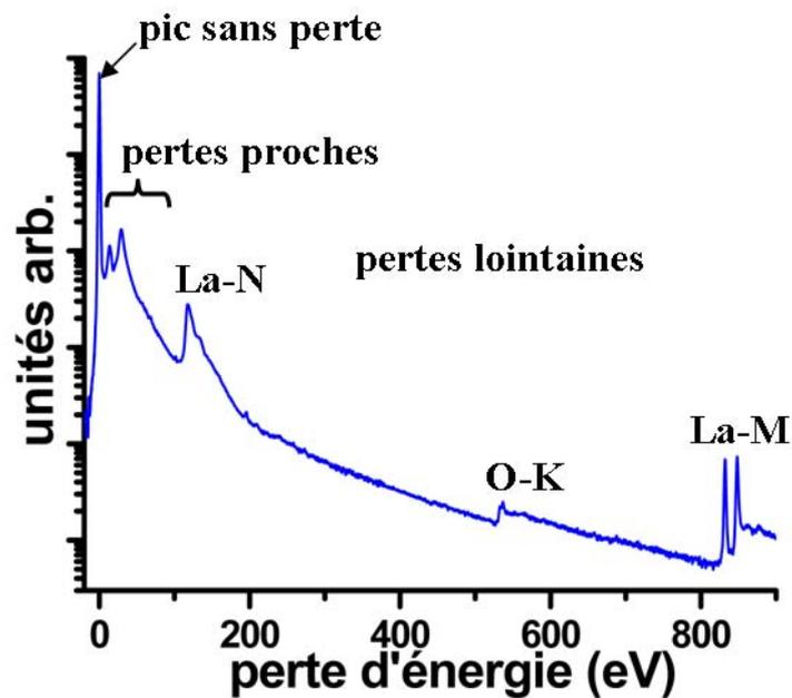
Figure A3-7 : spectre EELS de  $\text{La}_2\text{O}_3$  dans la fenêtre d'énergie [0-900] eV. L'échelle d'intensité est logarithmique pour permettre la vision globale du spectre dont la dynamique est très importante.
