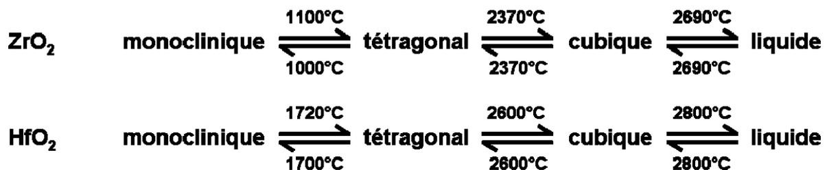
Figure 2-2 : Polymorphisme de ZrO<sub>2</sub> et HfO<sub>2</sub>, à l'état massif, en fonction de la température à pression atmosphérique [Wang1992].
