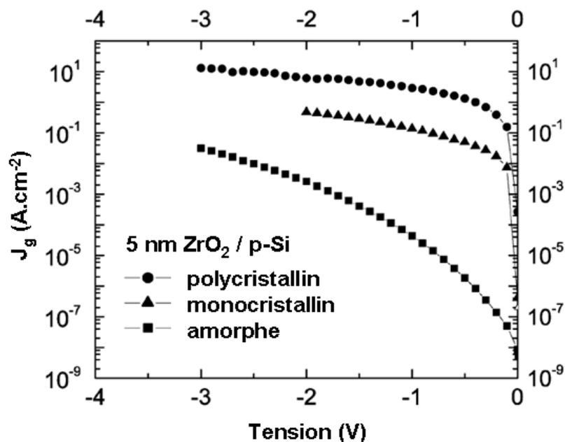
Figure 2-5 : influence de l'état de cristallisation sur la densité de courant de fuite  $J_g$  dans un film mince  $ZrO_2$  déposé sur Si [Kwo2003].
