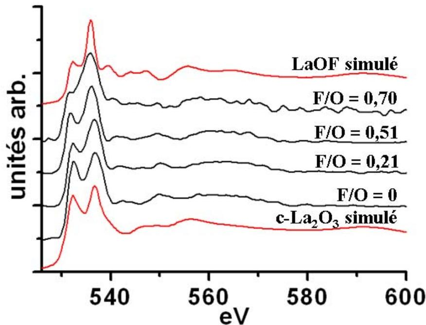
Figure 4-10 : ELNES au seuil O-K mettant en évidence l'effet de l'incorporation de fluor sur les structures fines. Les spectres expérimentaux en noir sont comparés aux spectres calculés de  $c\text{-La}_2\text{O}_3$  et LaOF. Dans ce dernier cas, les structures fines des trois variétés cristallographiques étant très similaires, nous avons seulement reporté celle de la phase  $c\text{-LaOF}$ .
