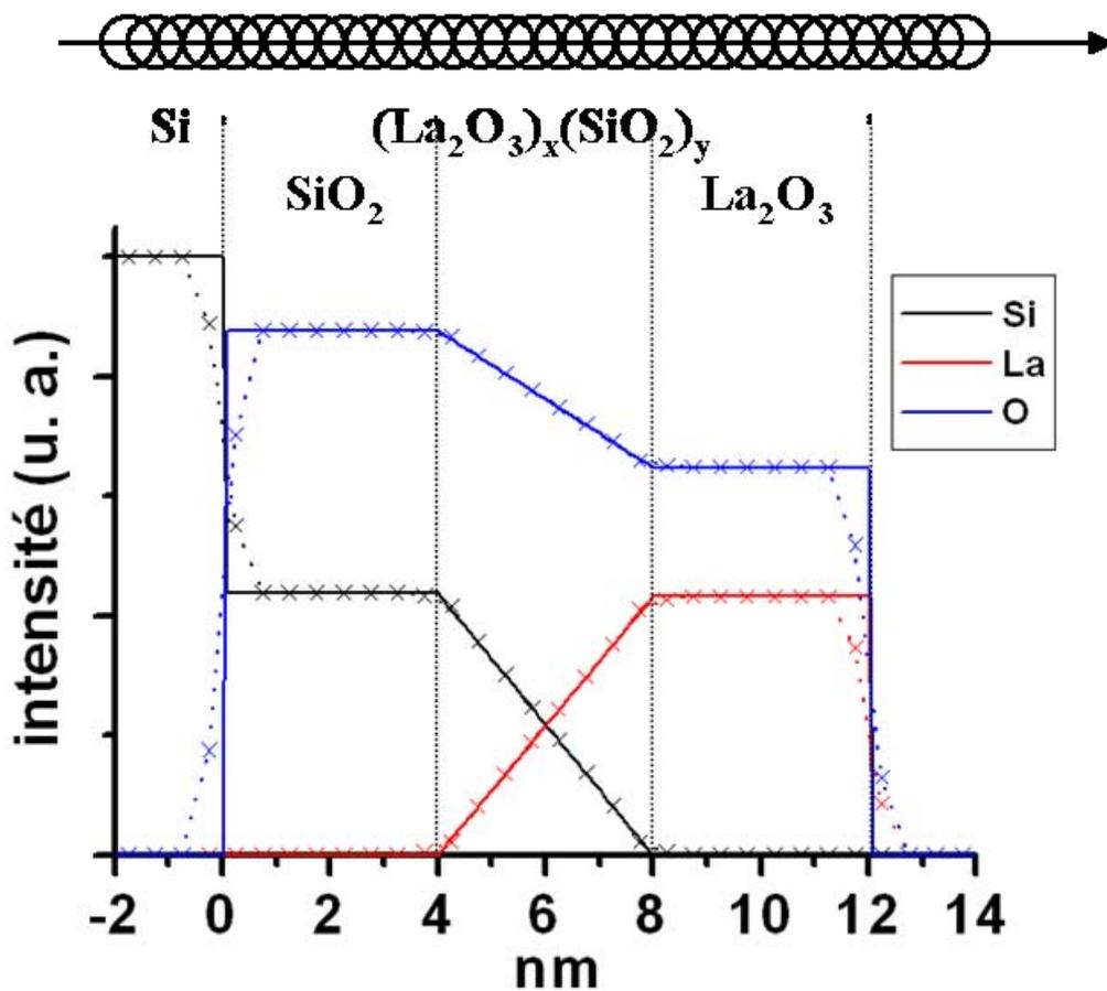
Figure 3-25 : positions géométriques des différentes couches de l'empilement  $\text{Si}/\text{SiO}_2/(\text{La}_2\text{O}_3)_x(\text{SiO}_2)_y/\text{La}_2\text{O}_3$  (traits continus) et profils chimiques simulés (pointillés, croix) dans le cas d'une sonde de 1 nm de diamètre et d'un pas de déplacement de 0,5 nm.
