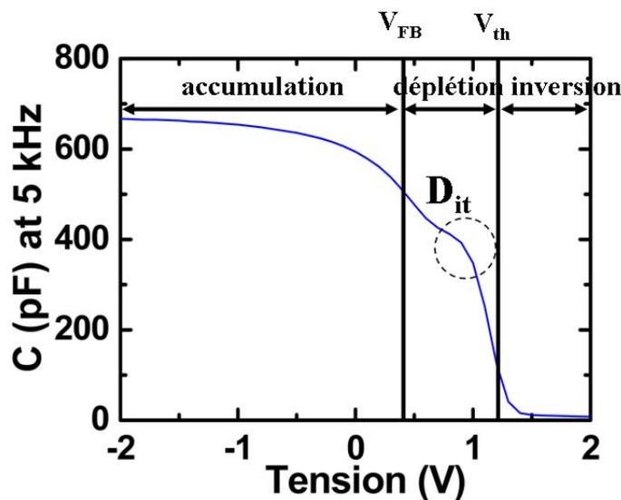
Figure 3-6 : profil capacité-tension C-V (d'après données MDM).
