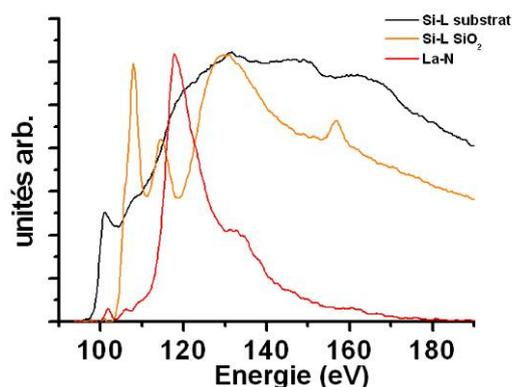
Figure 3-23 : distributions caractéristiques représentatives de Si-L dans le Si et dans la silice et La-N dans le film d'oxyde.
