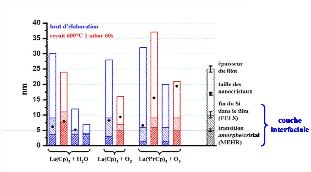
Figure 4-18 : résumé des épaisseurs totales, chimiques et structurales des films élaborés à partir des précurseurs  $\text{La}(\text{Cp})_3 + \text{H}_2\text{O}$ ,  $\text{La}(\text{Cp})_3 + \text{O}_3$  et  $\text{La}(\text{PrCp})_3 + \text{O}_3$ . Les tailles de nanocristaux correspondantes sont également indiquées.
