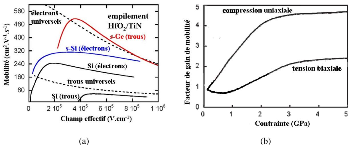
Figure 1-7 : (a) mobilité des porteurs dans le cas du silicium et du germanium, éventuellement contraints (s-) [Halimaoui2007] et (b) une compression uniaxiale est plus favorable qu'une tension biaxiale pour l'augmentation de la mobilité des porteurs [Thompson2006].
