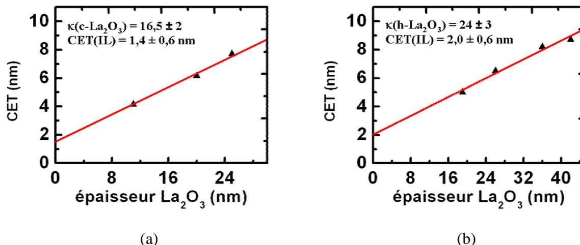
Figure 4-20 : courbes CET vs épaisseur du film pour les combinaisons de précurseurs (a)  $\text{La}(\text{Cp})_3 + \text{H}_2\text{O}$  et (b)  $\text{La}(\text{}^i\text{PrCp})_3 + \text{O}_3$  après recuit.
