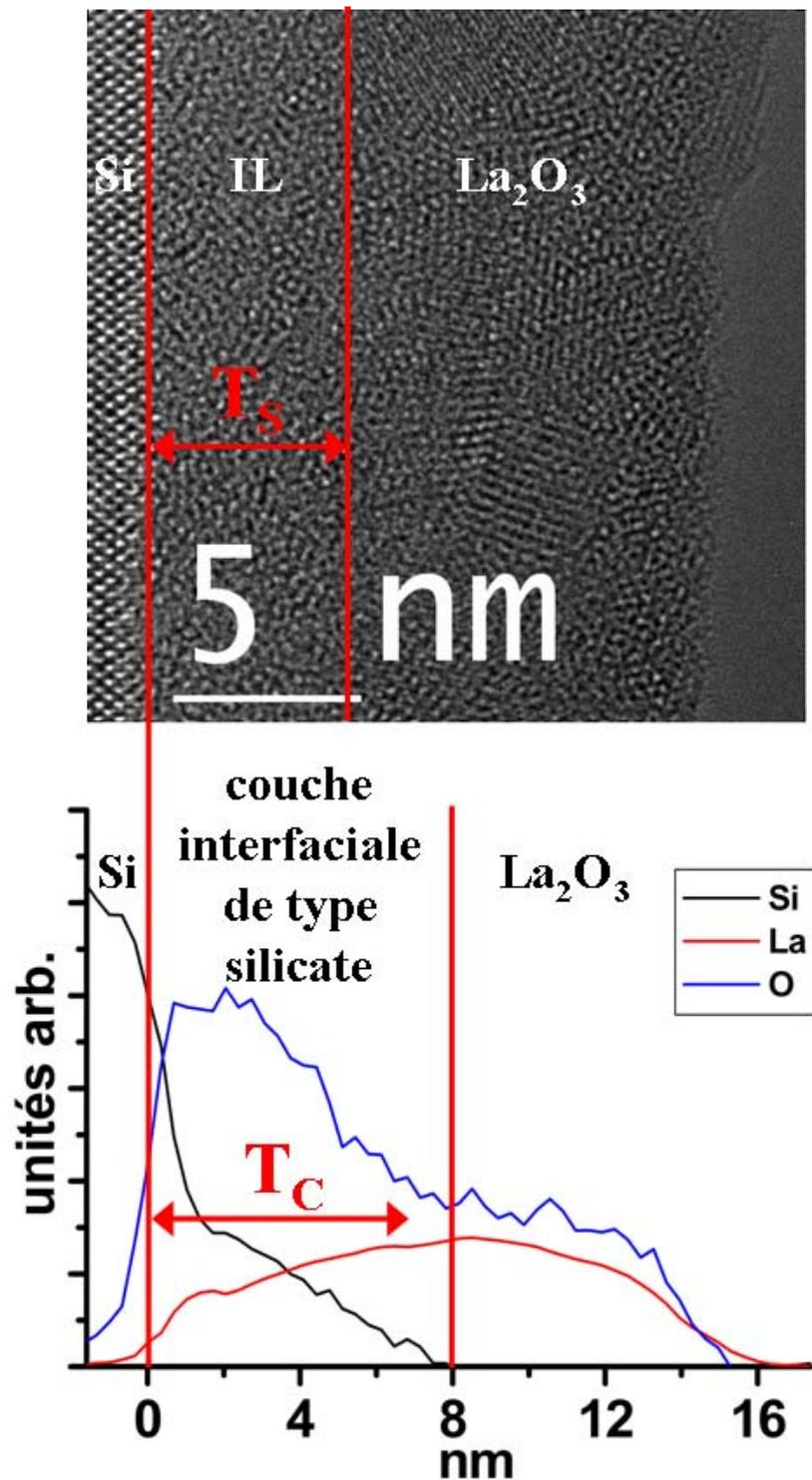
Figure 3-26 : détermination des épaisseurs structurale  $T_S$  et chimique  $T_C$  de la couche interfaciale dans le cas du système Si/La<sub>2</sub>O<sub>3</sub>.
