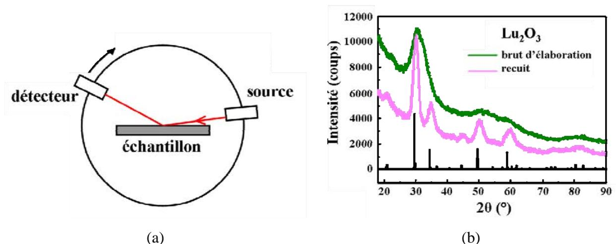
Figure 3-2 : (a) principe de l'XRD et (b) profil de l'intensité en fonction de l'angle de diffraction. Cas de  $\text{Lu}_2\text{O}_3$  brut d'élaboration et recuit [Scarel2004].
