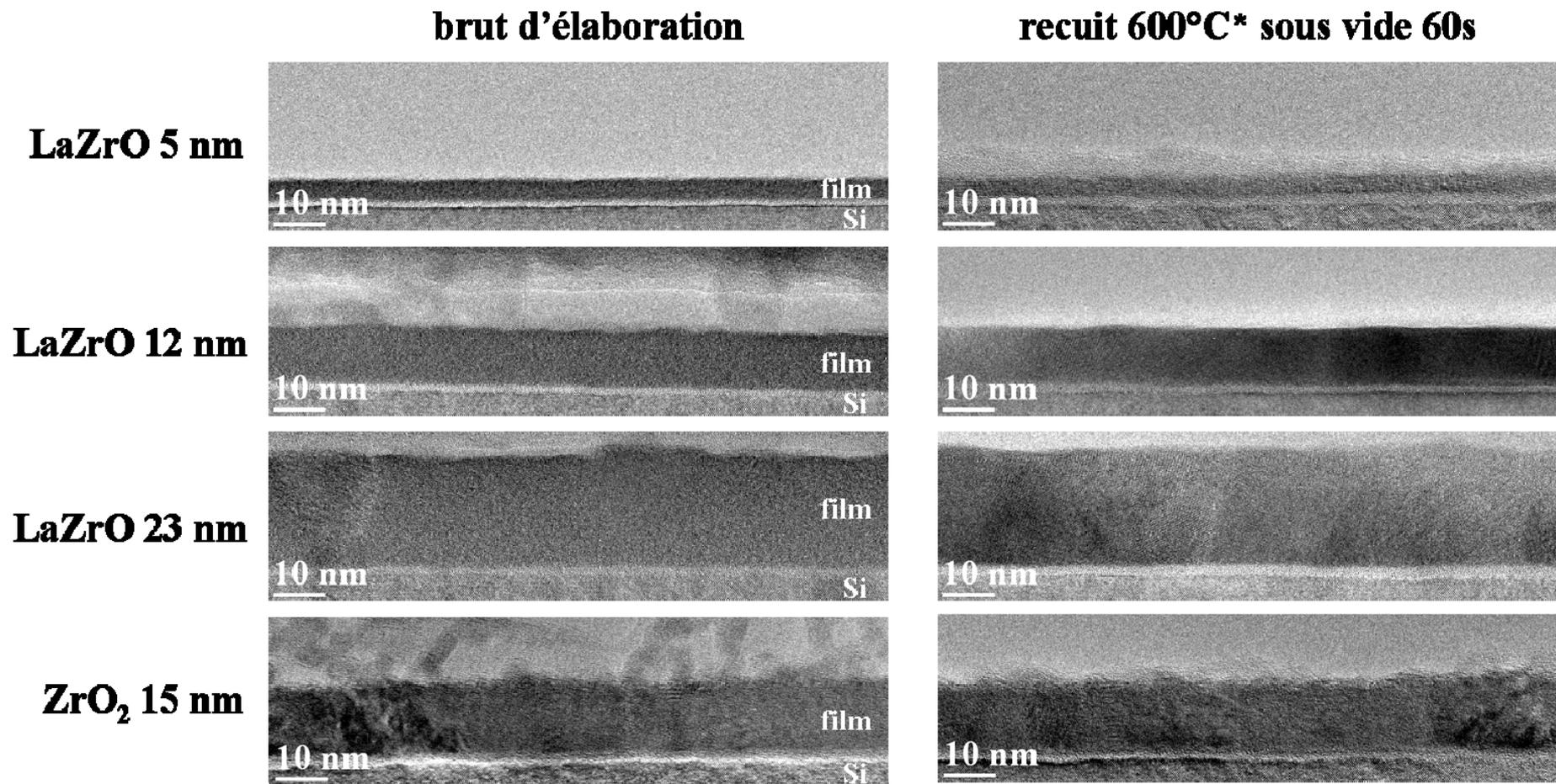
Figure 5-2 : observation MET en section transverse des films LaZrO de 5, 12 et 23 nm d'épaisseur et comparaison avec un film ZrO<sub>2</sub> de 14 nm d'épaisseur.
