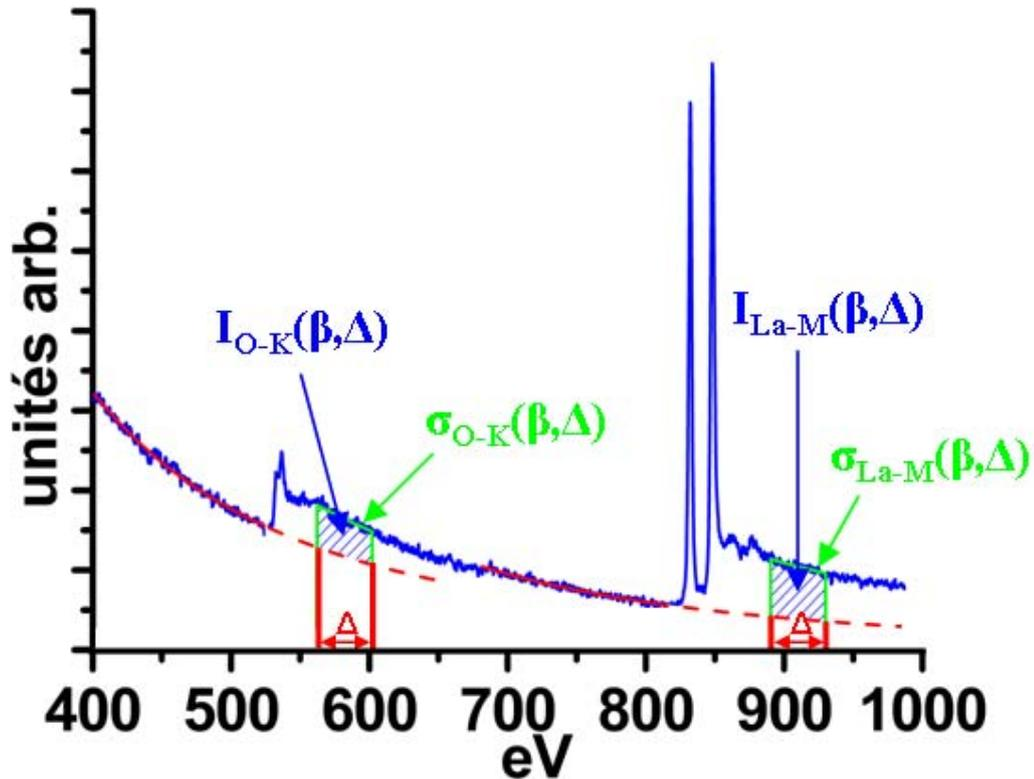
Figure 3-21 : Analyse quantitative classique des distributions caractéristiques : extraction du fond continu (rouge) et détermination de l'aire sous-tendue  $I$  dans la fenêtre d'intégration en énergie  $\Delta$  divisée par la section efficace partielle  $\sigma$  correspondante (vert).
