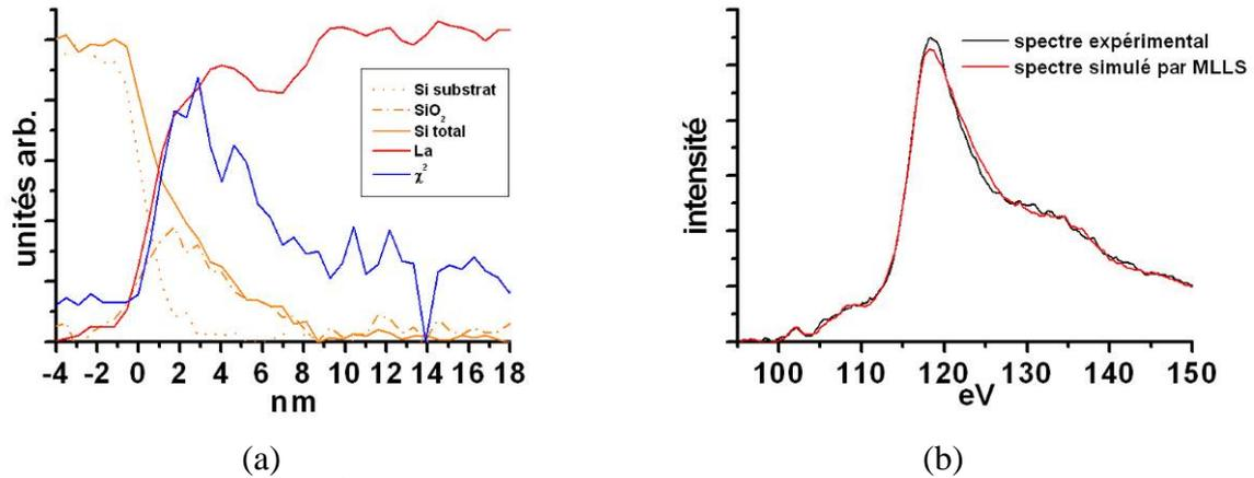
Figure 3-24 : (a) valeur de  $\chi^2$  obtenue en simulant les spectres expérimentaux par Si-L (substrat + silice) et La-N et (b) comparaison du signal expérimental au signal simulé en un endroit où silicium et lanthane coexistent (cas d'une interface Si/La<sub>2</sub>O<sub>3</sub>).
