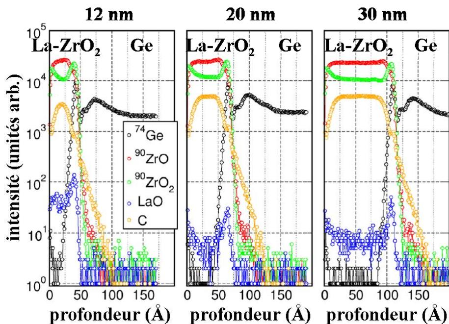
Figure 6-3 : analyses ToF-SIMS des films  $ZrO_2$  dopés au lanthane d'épaisseur 12, 20 et 30 nm bruts d'élaboration.
