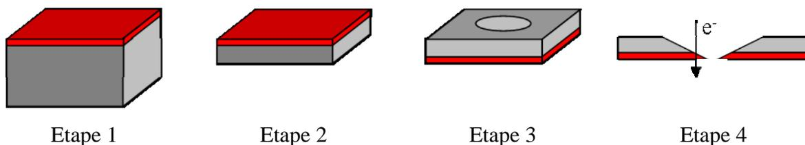
**Etape 1** : découpe à la scie à fil diamanté d'un carré de 2 mm de côté.
