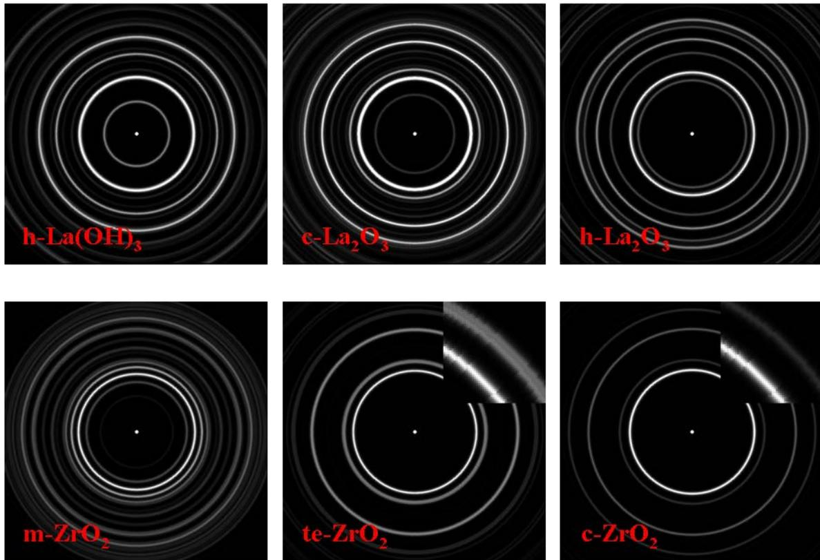
Figure 3-12 : diffractions électroniques simulées. En haut :  $\text{La(OH)}_3$ ,  $\text{c-La}_2\text{O}_3$  et  $\text{h-La}_2\text{O}_3$  et en bas :  $\text{m-ZrO}_2$ ,  $\text{te-ZrO}_2$  et  $\text{c-ZrO}_2$ .
