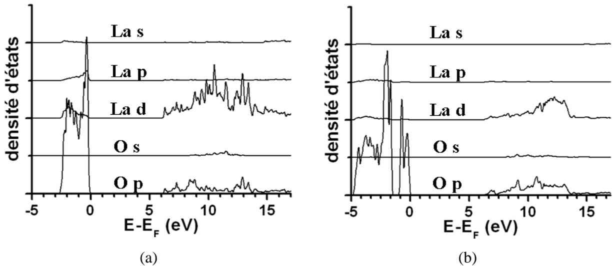
Figure 3-29 : densités d'états calculées par la méthode Wien2k des composés (a) *c*-La<sub>2</sub>O<sub>3</sub> et (b) *h*-La<sub>2</sub>O<sub>3</sub>.
