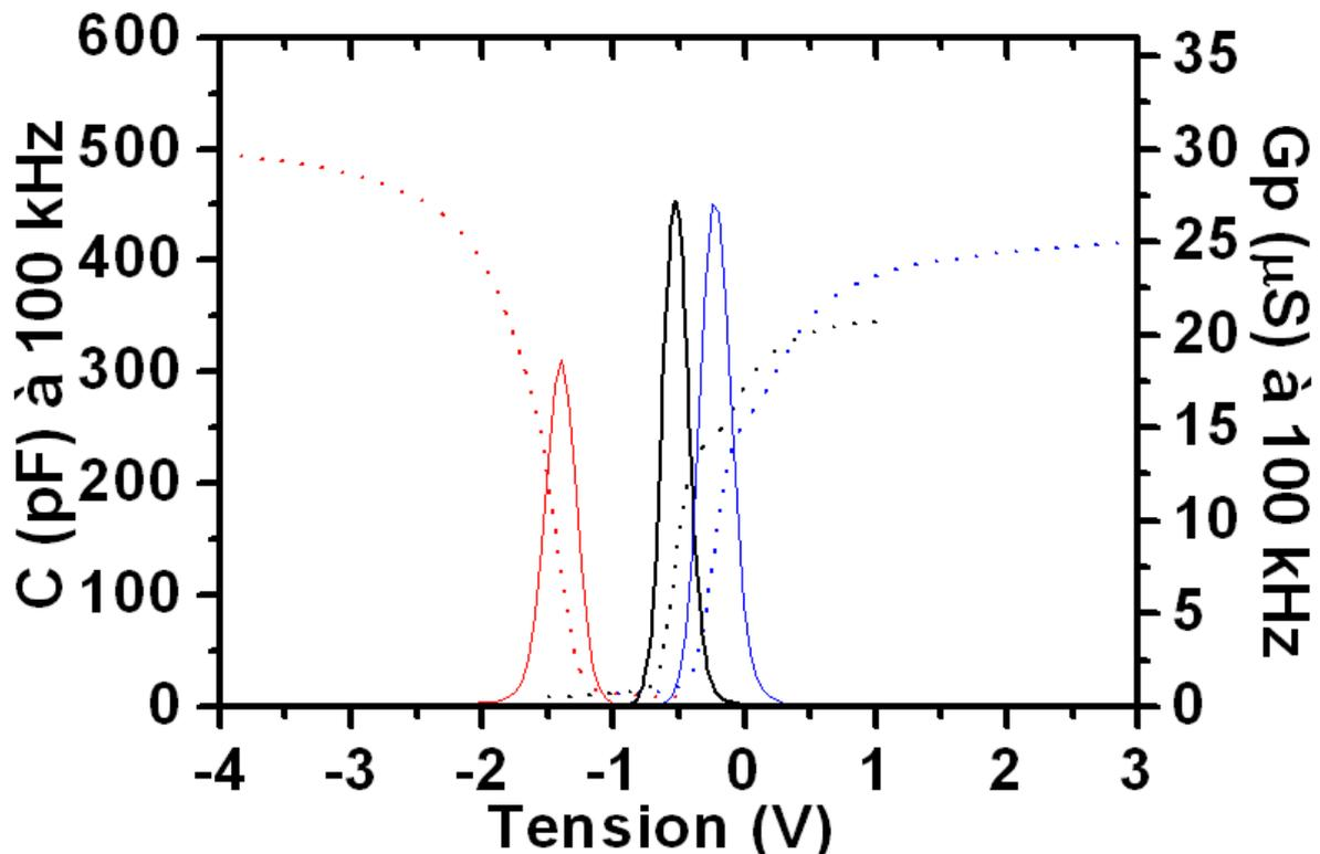
Figure 4-19 : mesures C-V et Gp-V pour  $\text{La}(\text{Cp})_3 + \text{H}_2\text{O}$  (noir),  $\text{La}(\text{Cp})_3 + \text{O}_3$  (rouge) et  $\text{La}(\text{PrCp})_3 + \text{O}_3$  (bleu).
