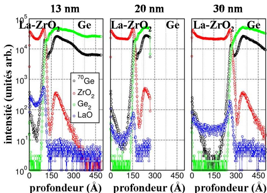
Figure 6-4 : analyses ToF-SIMS des films  $ZrO_2$  dopés au lanthane d'épaisseur 13, 19 et 29 nm recuits mettant en évidence la diffusion du germanium dans les films recuits.
