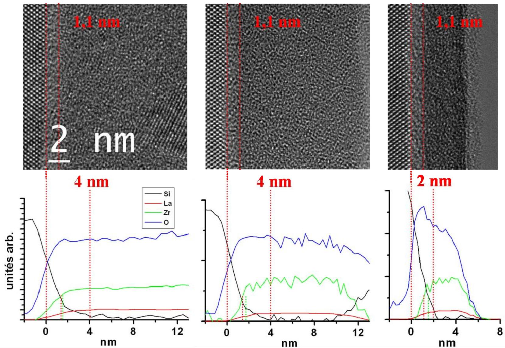
Figure 5-8 : épaisseurs chimiques et structurales pour les films d'épaisseur (a) 23 nm, (b) 12 nm et (c) 6 nm bruts d'élaboration.
