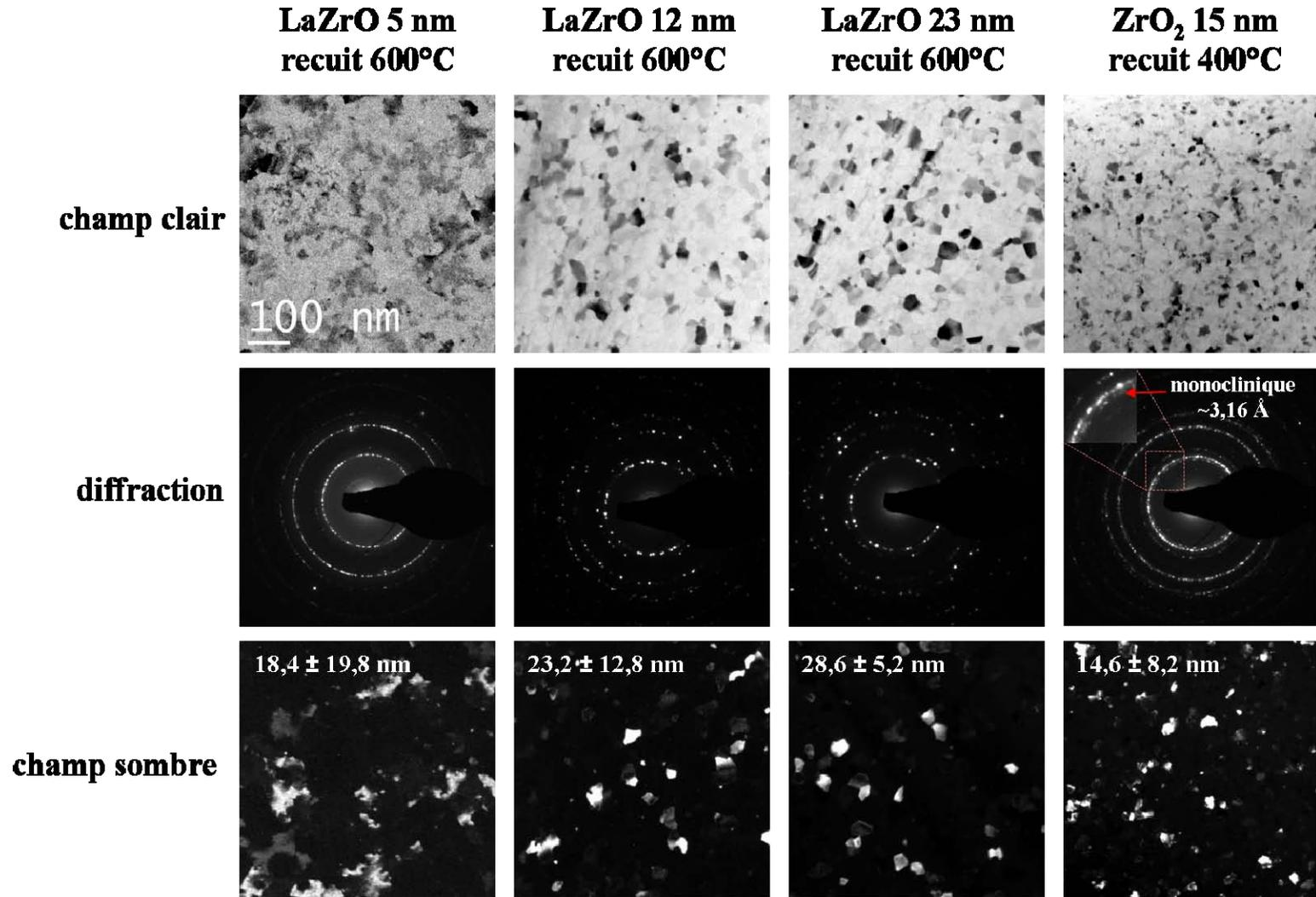
Figure 5-4 : images champ clair, diffraction électronique et champ sombre des films LaZrO et ZrO<sub>2</sub> recuits respectivement à 600°C 60s sous vide et 400°C 60s sous N<sub>2</sub>. Sur les champs sombres sont insérées les tailles moyennes des nanocristaux. Noter la présence d'anneaux supplémentaires dans le film ZrO<sub>2</sub> (épaisseur 15 nm) associés à la phase monoclinique de ZrO<sub>2</sub>.
