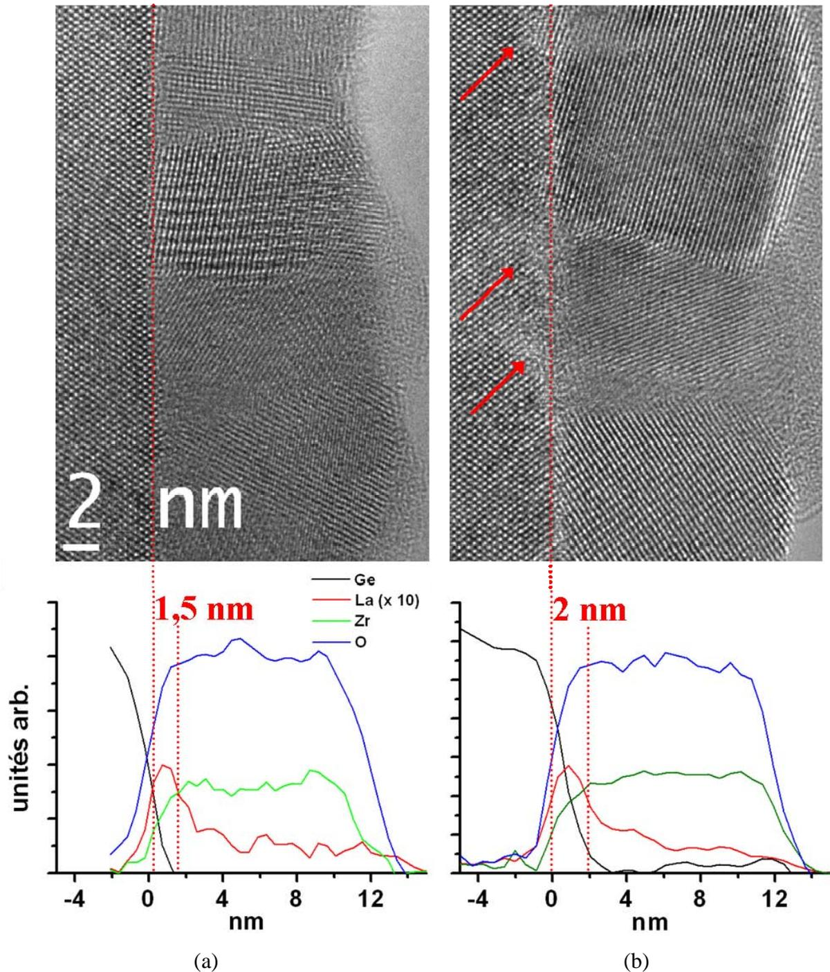
Figure 6-2 : Modification de l'interface de film  $ZrO_2$  dopés au lanthane après recuit à  $400^\circ C$  sous  $N_2$  pendant 60s. Image MEHR et profils EELS (a) avant recuit et (b) après recuit. Les flèches sur l'image MEHR montrent les lieux de consommation du germanium.
