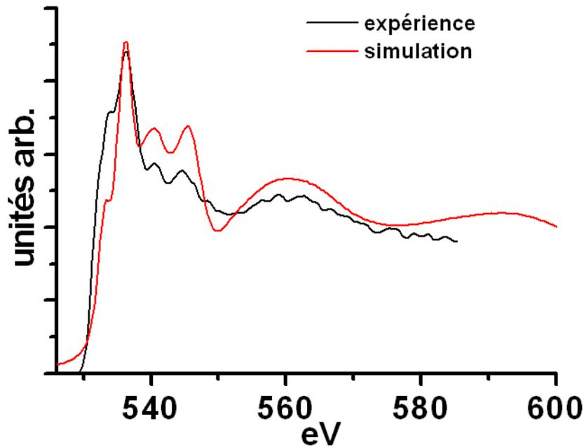
Figure 4-4 : seuil K de l'oxygène de h-La(OH)<sub>3</sub> expérimental et simulé.
