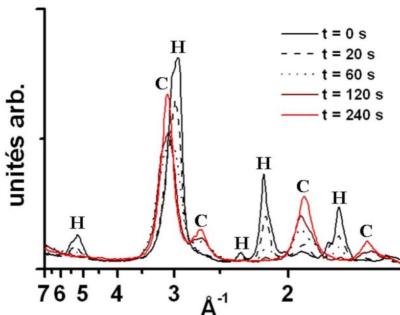
Figure 4-8 : évolution de l'intensité des anneaux en fonction du temps d'exposition sous le faisceau d'électrons. H et C représentent respectivement  $h\text{-La}(\text{OH})_3$  et  $c\text{-La}_2\text{O}_3$ .
