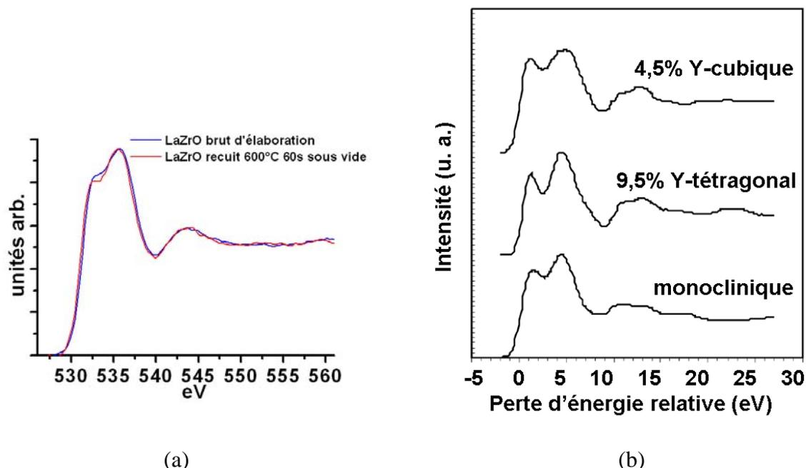
Figure 5-6 : comparaison des structures fines ELNES du seuil K de l'oxygène dans les films LaZrO bruts d'élaboration et recuits à 600°C 60s sous vide avec celles de Y-ZrO<sub>2</sub> [McComb1996].
