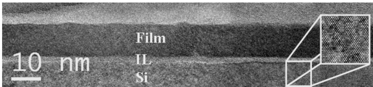
Figure 3-14 : image ( $\times 145.000$ ) permettant d'apprécier l'homogénéité du film et de mesurer les épaisseurs des couches qui le constituent.
