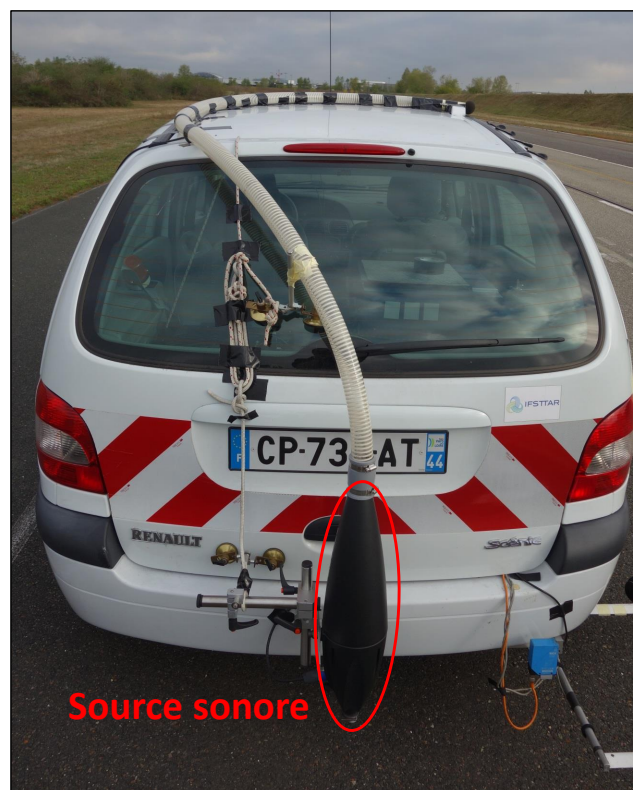
FIGURE 4.5 – Système de fixation de la source et tuyau de déport.
