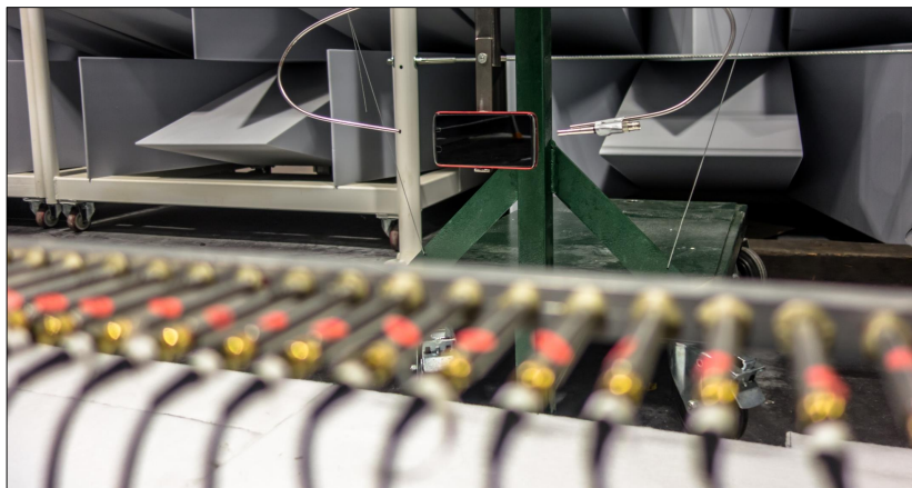
FIGURE 3.3 – Antenne de microphones faisant face au pendule et à la source.
