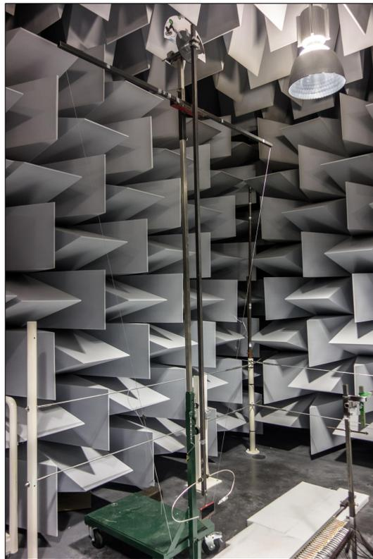
FIGURE 3.1 – Pendule utilisé pour l'expérience en salle semi-anéchoïque.
