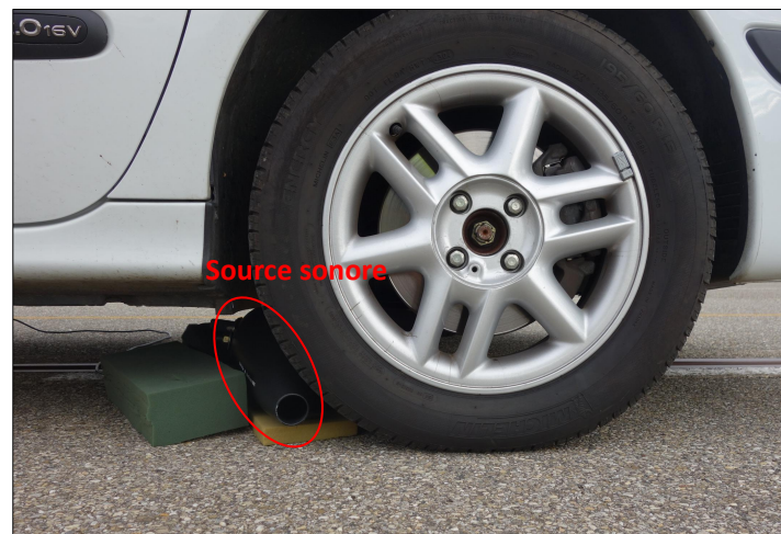
FIGURE 4.8 – Position de la source dans la deuxième configuration statique.
