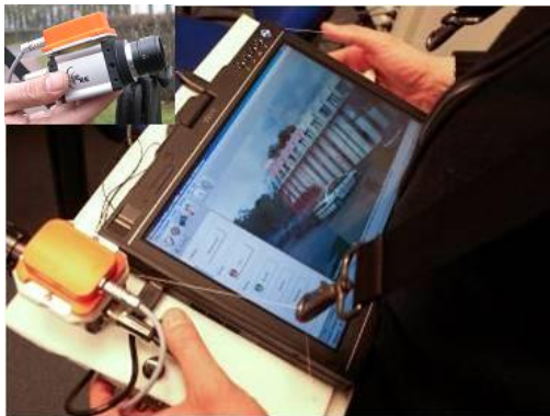
(a) Tablette PC, caméra et centrale inertielle
