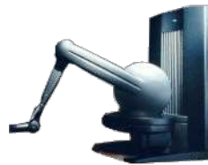
(h) Restitution haptique (Phantom - Sensable)
