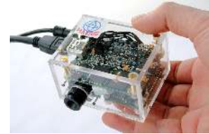
(f) Capteur hybride caméra- centrale inertielle (Matris – Xsens)
