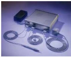
(a) Capteur magnétique (Fastrak – Polhemus)
