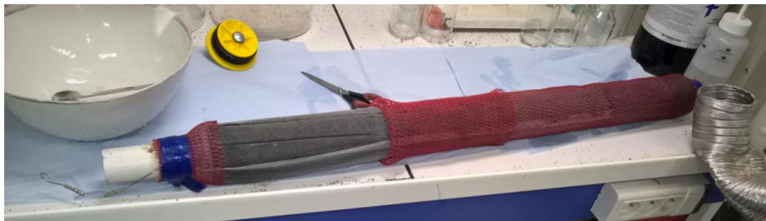
Figure 6.7 : Préparation d'un PFM pour l'extraction des composés organiques du charbon actifs
