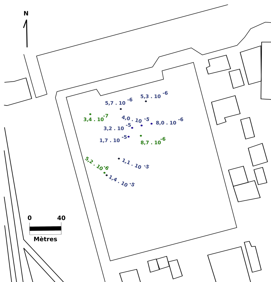
Figure 3.6 : Champ de conductivité hydraulique mesuré ( m.s^{-1} ) (vert) aquifère tertiaire alpha, (bleu) aquifère quaternaire
