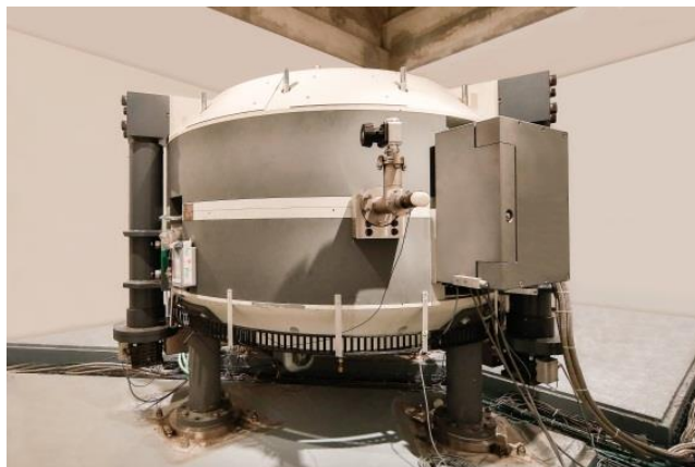
Figure 145 Le synchrocyclotron supraconducteur qui va équiper la ligne de protonthérapie haute énergie (235 MeV) au centre Lacassagne à Nice.
