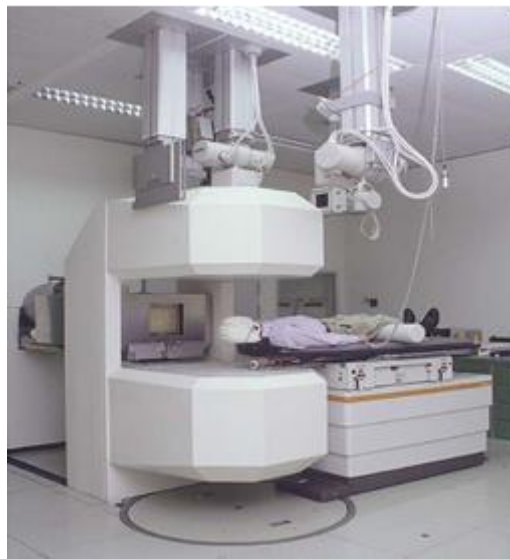
Figure 149 Salle de traitement par hadronthérapie montrant la disposition des détecteurs TEP autour du patient pendant l'irradiation par faisceau d'ions carbone. (photographie: A. Zschau, GSI Darmstadt)
