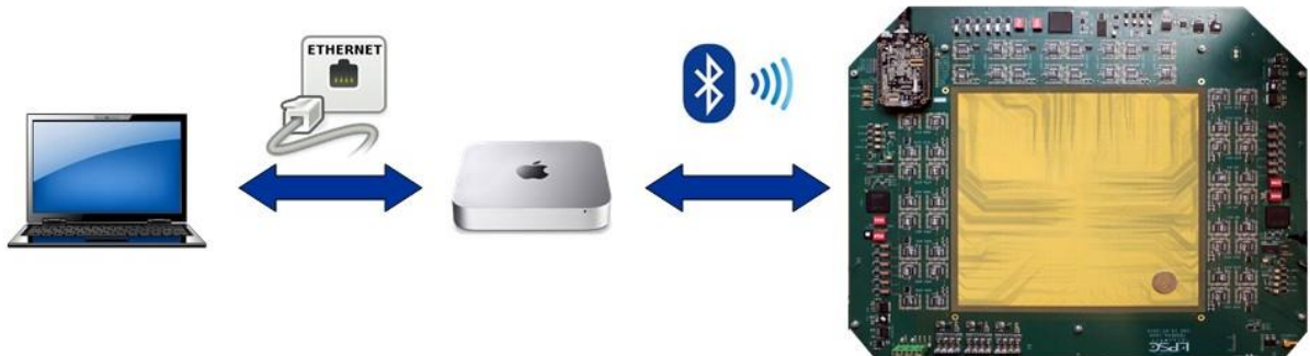
Figure 139 Prototype TRADERA échelle 1, TRADERA 1600 (1600 voies de lectures)
