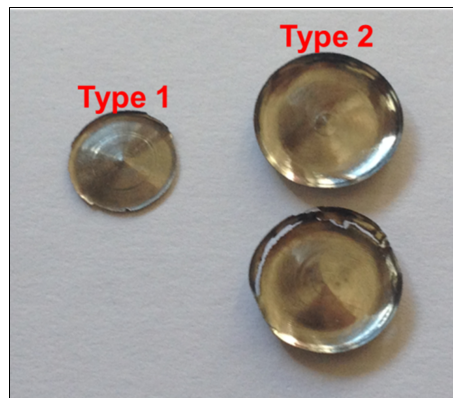
FIGURE 3.15 – Différents types de capsule observé dans le Ti6Al4V
