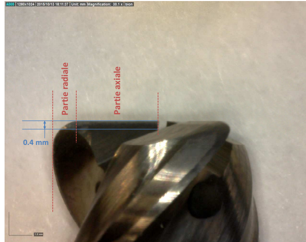
FIGURE 2.26 – Taillage de la dent de l'outil utilisé, photographié à l'aide d'un microscope Dino-lyte
