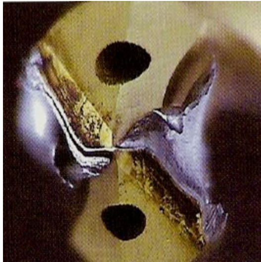
FIGURE 1.18 – Déformation plastique en bout d'outil [Coromant]
