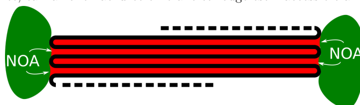
(b) Les serpentins de notre réacteur présentés sur la figure 2.14 sont en théorie impossible à réaliser car la NOA enferme l'air présent dans les parties en rouge. Cette limitation peut en fait être surmontée grâce à la perméabilité du PDMS aux gaz.
