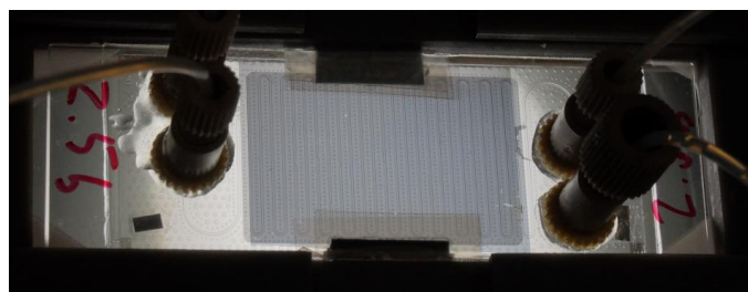
(d) Écoulement diphasique liquide-gaz dans une ancienne version du réacteur.
