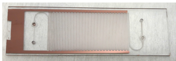
Figure 6.2 – Électrode de cuivre en forme de peigne déposée sur un côté d’un réacteur en verre.
