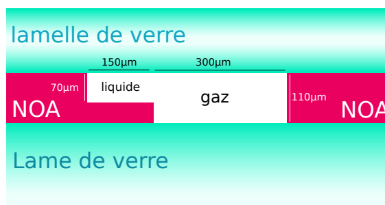
Figure 2.10 – Vue en coupe d'un canal à deux profondeurs. Deux lieux sont ainsi délimités, où vont s'écouler le liquide ou le gaz (dans la direction perpendiculaire au dessin). Plus de détails sur la fabrication dans la partie IV.
