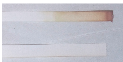
Figure 4.6 – Bande test de la fonction peroxyde après contact avec le liquide sortant du réacteur (haut, test positif), par rapport au cyclohexane introduit dans le réacteur (bas, test négatif).
