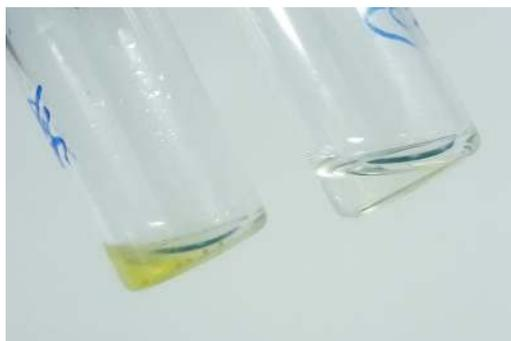
**Figure 3.11** – Phase liquide en sortie d’un réacteur BiFlow 2.7 avec une décharge de  $O_2$  à 2 kHz et 6 kV dans une configuration simple DBD avec électrode d’or en contact avec le plasma (à gauche) et dans une configuration double DBD (à droite).
