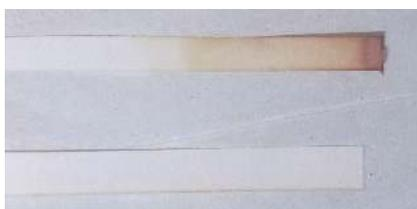
**Figure 4.6** – Bande test de la fonction peroxyde après contact avec le liquide sortant du réacteur (haut, test positif), par rapport au cyclohexane introduit dans le réacteur (bas, test négatif).
