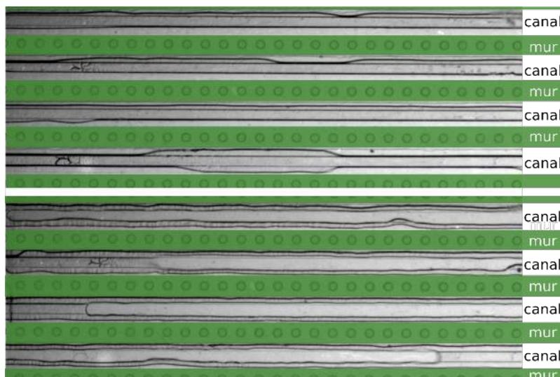
**Figure 2.31** – Écoulement d’argon ( $1 \text{ ml} \cdot \text{min}^{-1}$ ) et de cyclohexane ( $6 \mu\text{l} \cdot \text{min}^{-1}$ ). En haut, le liquide (plus foncé) reste bien des côtés du gaz (plus clair). En bas, avec une excitation AC de 5 kHz et  $6 \text{ kV}_{\text{pp}}$ , le liquide envahit la partie centrale, et va même jusqu’à l’occuper préférentiellement.
