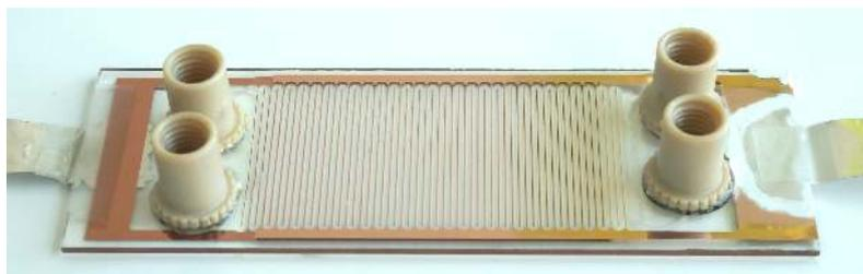
**Figure 6.2** – Électrode de cuivre en forme de peigne déposée sur un réacteur en verre.
