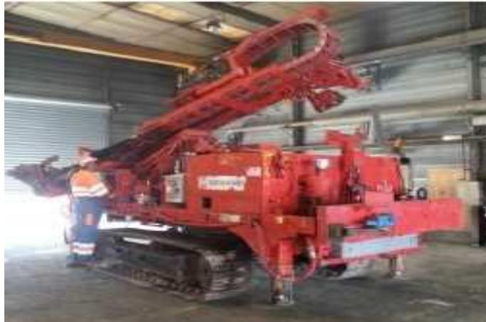
FIGURE 1.16 – Foreuse DCH114 (utilisée par SB)
