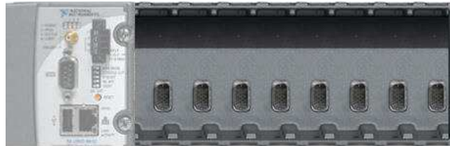
FIGURE 7.8 – Le châssis du Compact-RIO
