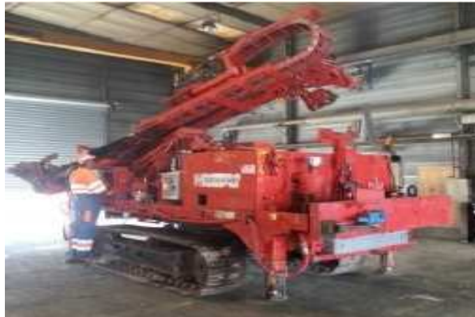
FIGURE 1.16 – Foreuse DCH114 (utilisée par SB)
