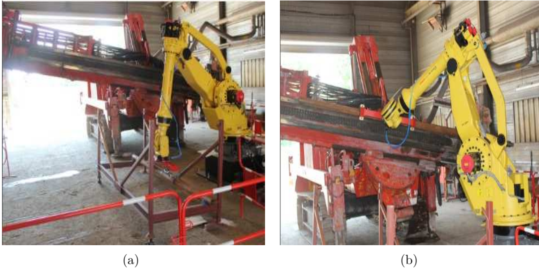
FIGURE 1.13 – (a) Manutention de la tige , (b) Vissage de la tête sur la tige
