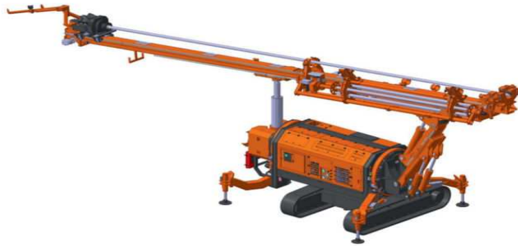
FIGURE 1.17 – Machine de forage de type MDT 140k (utilisée par SB)
