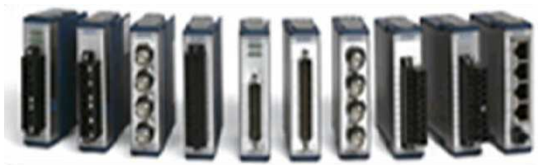
FIGURE 7.10 – Les modules E/S du Compact-RIO
