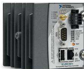
FIGURE 7.7 – Le contrôleur embarqué du Compact-RIO
