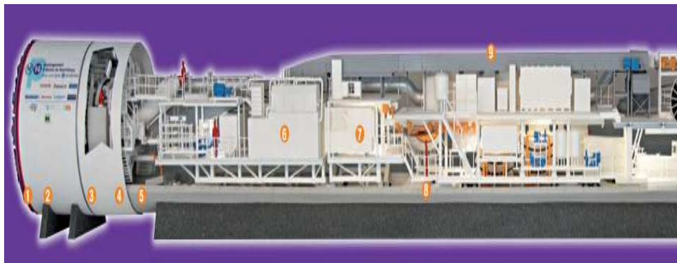
FIGURE 1.2 – Schéma explicatif du tunnelier
