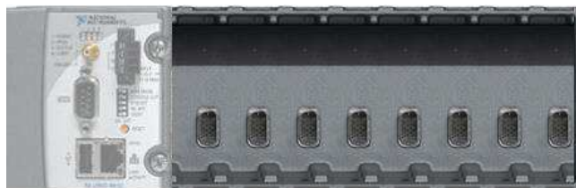
FIGURE 7.8 – Le châssis du Compact-RIO
