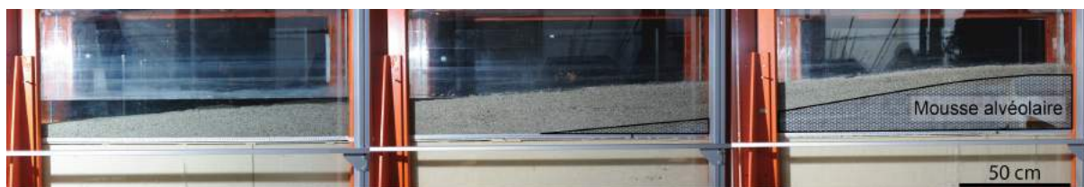
Figure III.4. Mise en place initiale du sédiment dans le canal. Le sédiment est lissé puis le canal est rempli d'eau ( H_{eau} = 17\text{ cm} ) avant la mise en marche du batteur.
