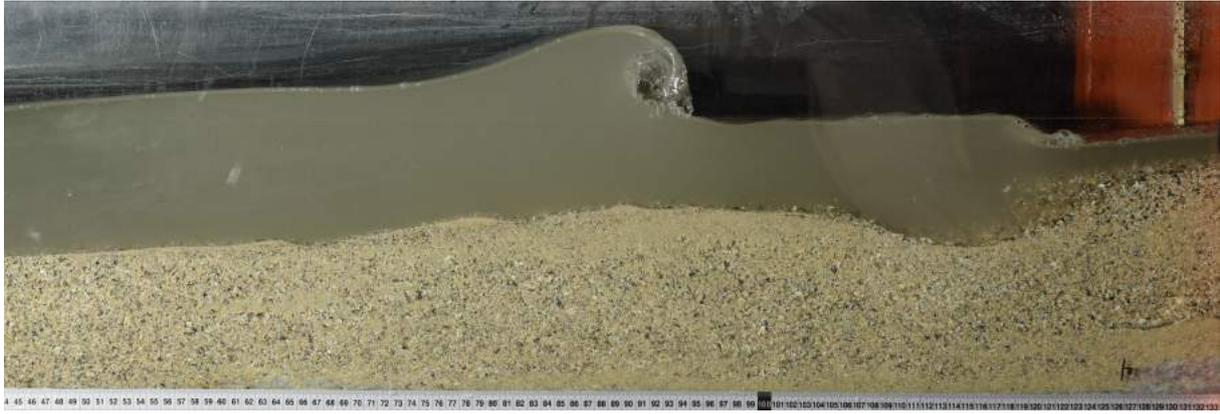
Figure III.11. Déferlement plongeant induit par la mobilisation d'un nouveau stock de sédiment.
