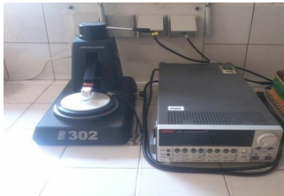
Figure II. 13. Station de mesure des quatre pointes
