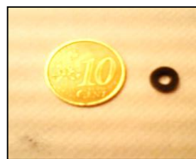
Figure V. 5. Le tore obtenu après sa fabrication
