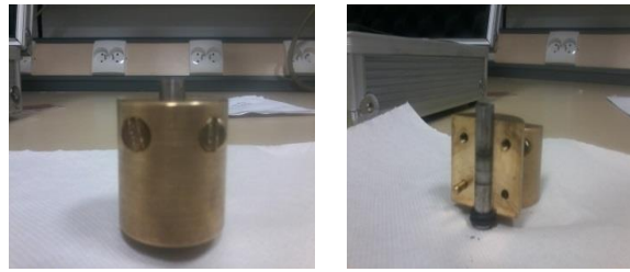
Figure V. 3. Moule utilisé pour la réalisation des tores
