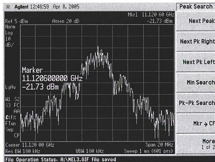
\*\*\* Figure 6.15 : spectre observé à la fréquence utile 11,120 GHz : porteuse pure modulée par la séquence de code pseudo-aléatoire de bruit à 2,5 MChips/s \*\*\*
