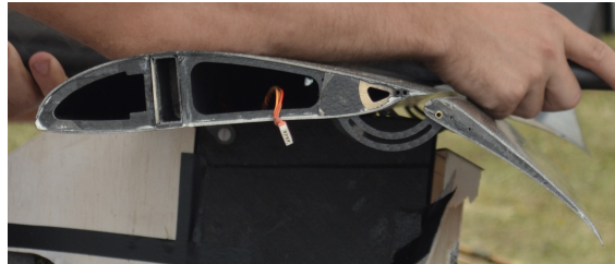
(α') Αεροτομή τύπου morphing (TU Munich). (β') Αεροτομή δύο στοιχείων (Univ. of Zagreb)
