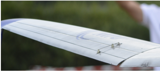
(α') Αεροτομή τύπου morphing (TU Munich). (β') Αεροτομή δύο στοιχείων (Univ. of Zagreb)
