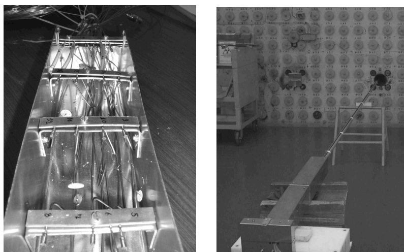
Figure 3 : Porte échantillon et câblage des 19 voies pour le placement dans le canal du réacteur [RAP13]
