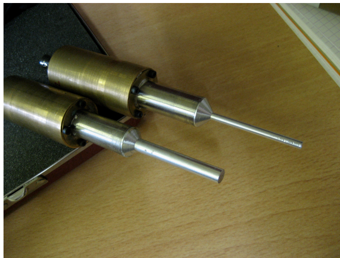
Figure 85. Sondes métalliques avec des diamètres de pointe différents, destinées à être posées sur la surface d'échantillons de bitumes.
