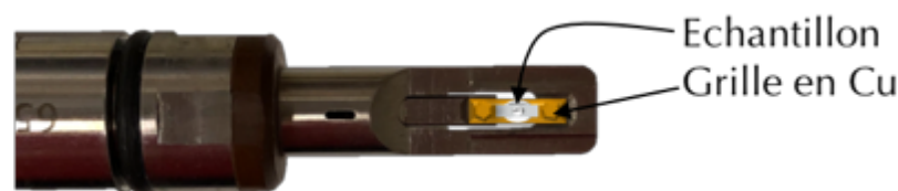
Figure II-2. Illustration du porte objet Gatan pour de la traction in situ en MET avec un échantillon sur une grille de cuivre.
