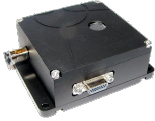
Figure 25 : Photo d'un module VECSEL à 2.3 μm commercialisé par la société INNOPTICS
