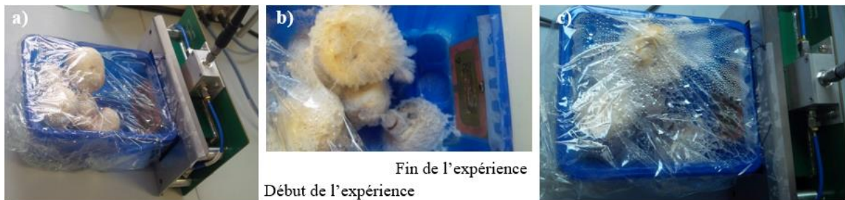
Figure 4-12 : Expérience avec 200 g de champignon de Paris recouverts d'un film alimentaire : a) début de l'expérience, b) et c) fin de l'expérience.
