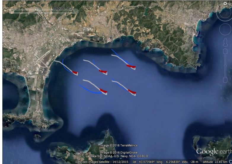
Figure 3.15 – Projet CADOR : Comparaison des trajectoires de dérive de surface pour la journée du 11/03/15. Bleu : observations ; rouge : trajectoires simulées par ICHTHYOP forcé par les champs de courants NIDOR192 ; gris : trajectoires simulées par ICHTHYOP forcé par des champs de courant calculés à partir de la vitesse du vent (5 %).
