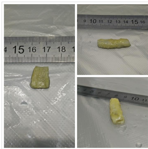
Рисунок 2.4 Вид образца децеллюляризованного желчного протока перед испытаниями в различных режимах
