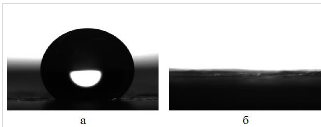
Рисунок 3.30 Визуализация краевого угла смачивания микроволокнистых каркасов на основе ПКЛ (а) без ПАВ и (б) с плуроником F-127. Световая микроскопия
